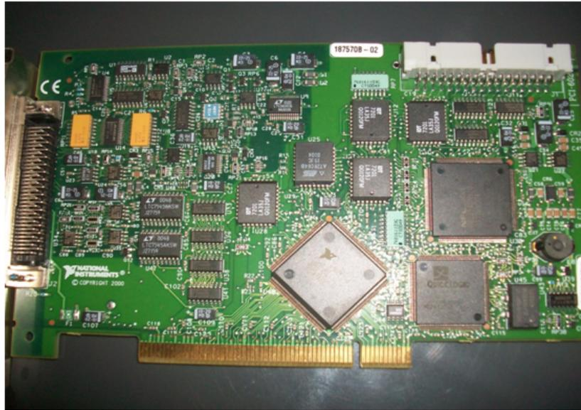
**Figura A.01:** Tarjeta de adquisición de datos PCI 6024e de National Instruments.
