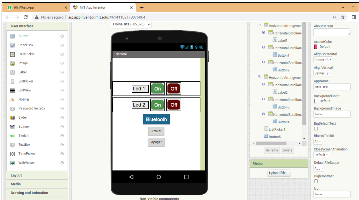
Figura 30. Creación de la Interfaz Gráfica de Usuario para el proyecto, utilizando el Diseñador de Componentes de MIT App Inventor 2
