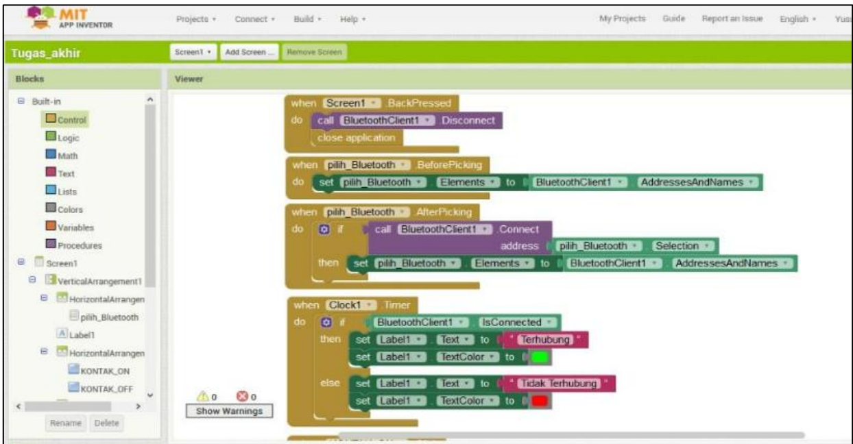
Figura 13. Programación de la aplicación móvil en App Inventor utilizando bloques de código.
