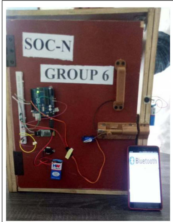
Figura 2. Mecanismo para abrir o cerrar la cerradura controlado por un teléfono inteligente.
