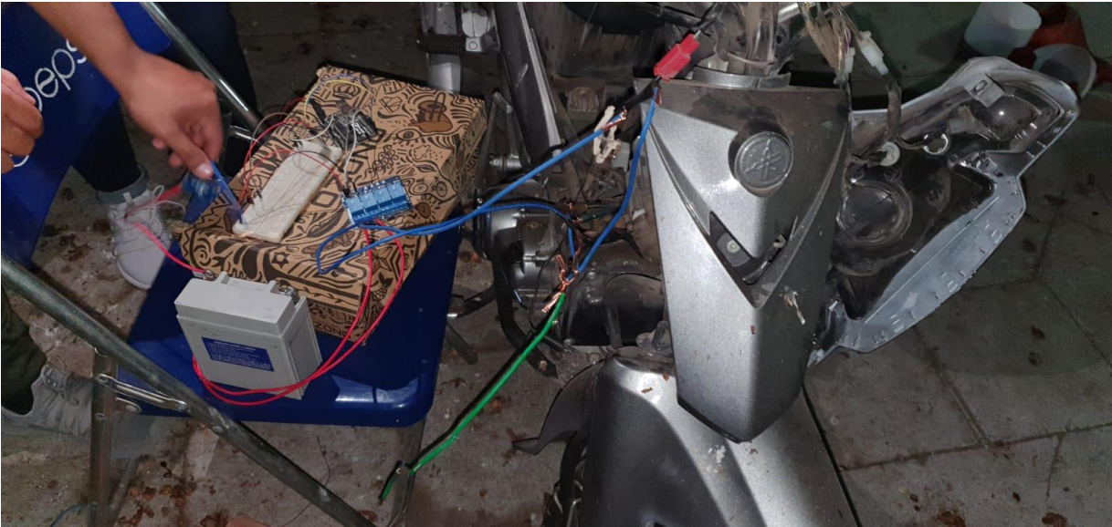
Figura 39. Conexión del sistema de seguridad con los componentes eléctricos de la motocicleta.
