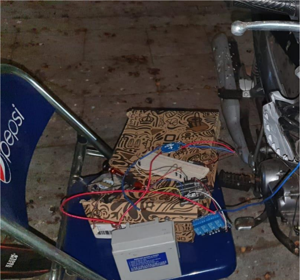
Figura 38. Armado del circuito físico para controlar los componentes eléctricos de la motocicleta.
