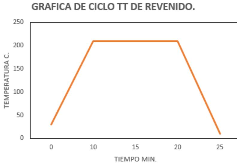
Figura 30 Ciclos de calentamiento y enfriamiento que representa el tratamiento térmico aplicado a un acero SISA D2 basado en la tabla 12.
