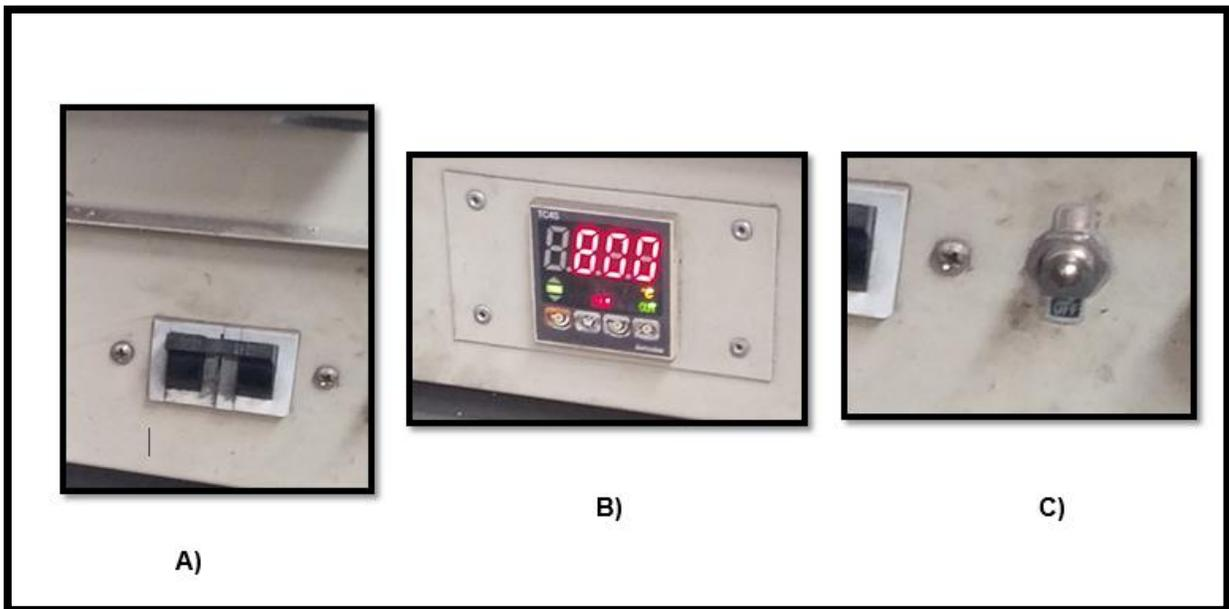
Figura 14 a) Encendido de mufla. B) display de temperatura y c) swich de alarma
