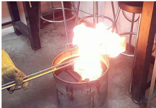
Figura 16 Piezas sometidas a enfriamiento en un contenedor con aceite
