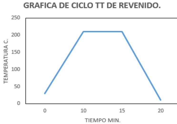
Figura 29 Ciclos de tratamiento térmico de a) temple y b) revenido acero SISA 01
