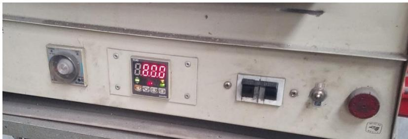
Figura 22 Proceso de ajuste de temperatura con respecto al proceso de revenido
