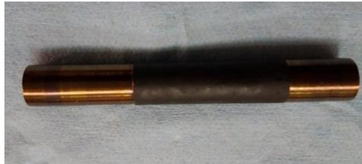
Figura 23 Probeta después del enfriamiento en aceite y limpia de exceso del mismo
