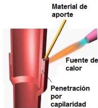
Figura 1. Soldadura por capilaridad [2].
