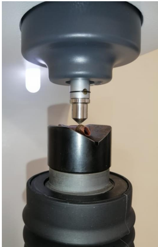
Figura 15. Probeta sometida al ensayo de dureza.
