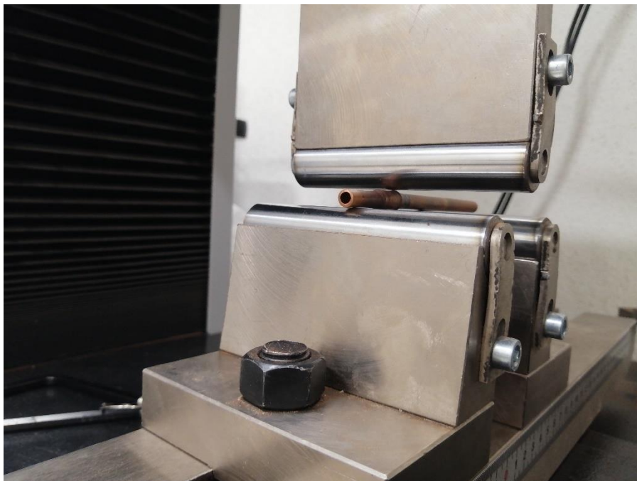
Figura 17. Probeta lista para ser sometida al ensayo de flexión en la máquina de ensayos universales ETM – 100KN.
