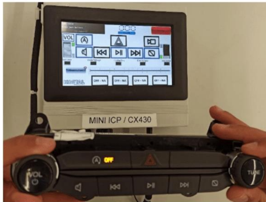
Figura 36 Probando la pieza "CX430 en la fixtura".
