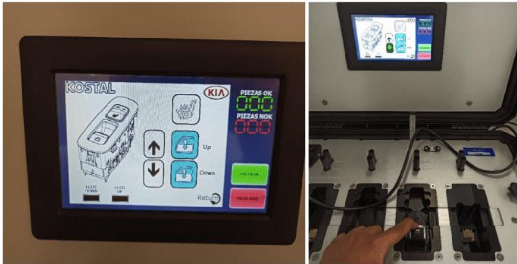
Figura 31 Fixtura "Rear" trabajando.
