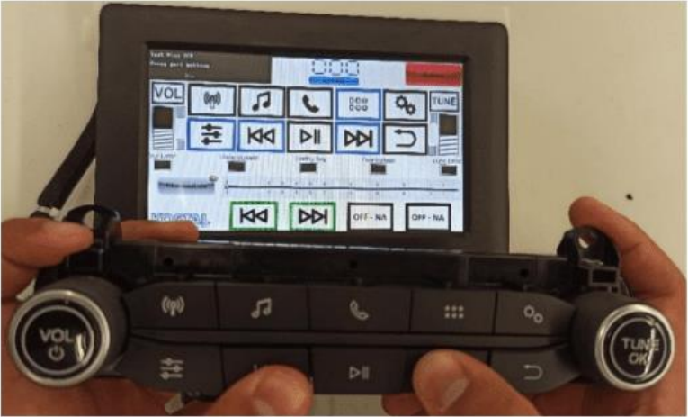
Figura 35 . Probando la pieza "Mini ICP" en la fixtura.
