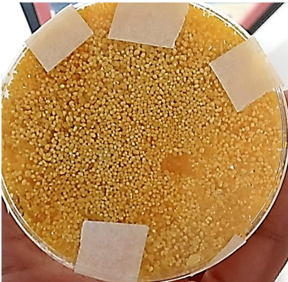
Figura 11. Citrato de calcio recolectado, implementando la técnica de laboratorio de identificación de citratos en jugo concentrado de naranja al 70% agua y 30% alcohol implementando secado y pesaje de citrato obtenido de 150 gr. de muestra de jugo.
