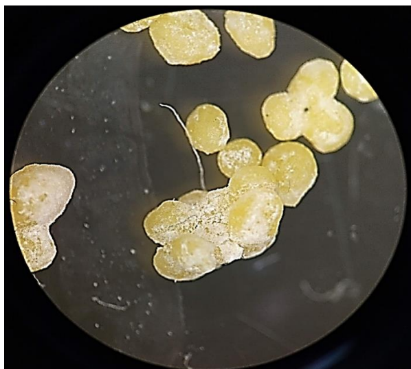
Figura 19. Citrato de calcio sin impurezas preservado en alcohol, observado en el microscopio en aumento de 40x, antes de la recristalización, en donde se observa partes blanquecinas en la mayoría de su estructura, además de tener una apariencia lechosa.
