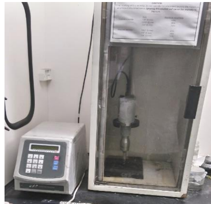
Fig.3.3.-Equipo de Sonoquímica utilizado en el proceso de reducción del compuesto CNT-Zn.
