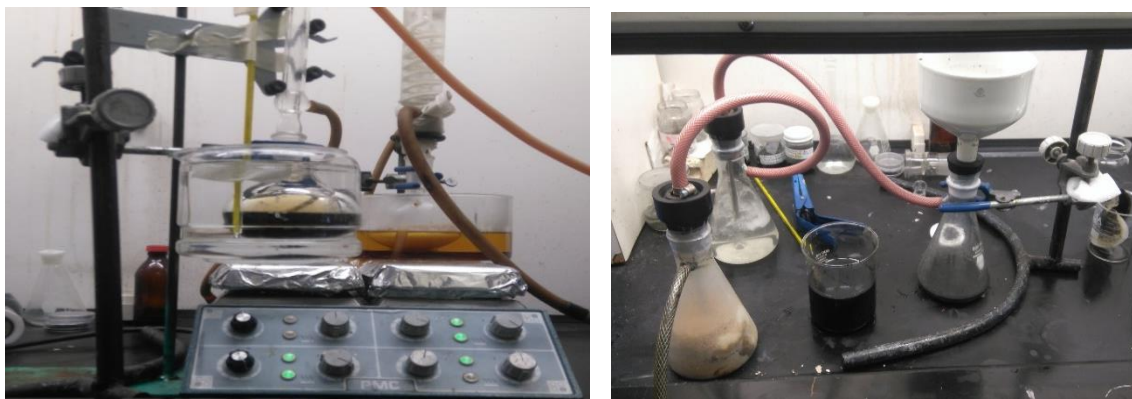
Fig.3.2.-Proceso de oxidación y filtración de los Nanotubos de Carbono recién funcionalizados.
