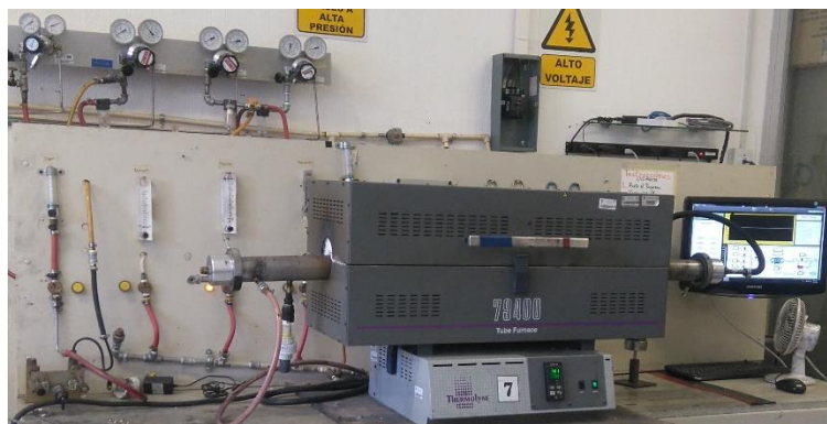
Figura 3.1.- Reactor marca Thermolyne modelo 79400 Tube Furnace utilizado durante el proceso de síntesis de los nanotubos de carbono NTC.
