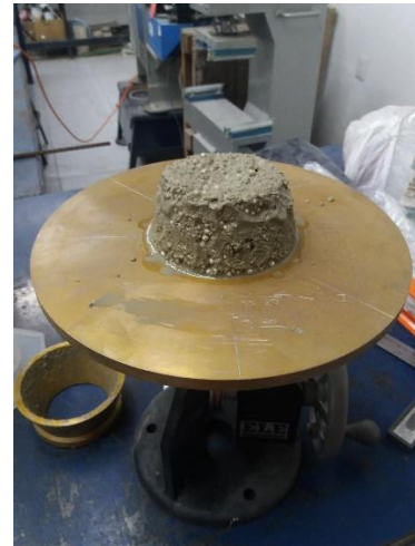
Fig. 3.12.- Retiro de cono.
