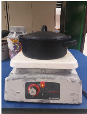
Fig. 3.41.- Espécimen hirviendo a 100 °C.
