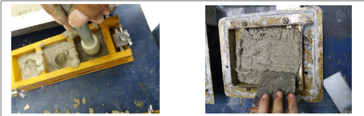
Fig. 3.22.- Colocación de los morteros tradicionales y alternativos en los moldes.
