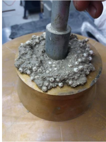
Fig. 3.11.- Llenado en capas.
