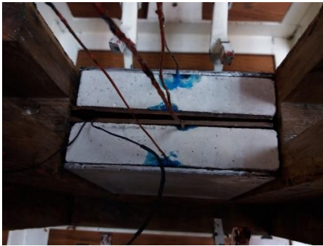
Fig. 3.36.- Colocación placas de cobre y aluminio. Fig. 3.37.- Resistencia eléctrica.
