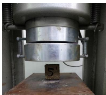
Fig. 3.27. Prueba a compresión de la proporción 1:4:1:3.
