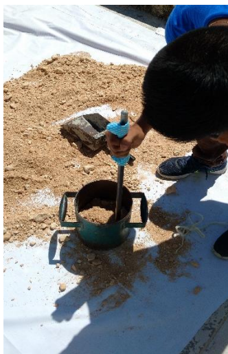
Fig. 3.15. Compactación del material con varillado.
