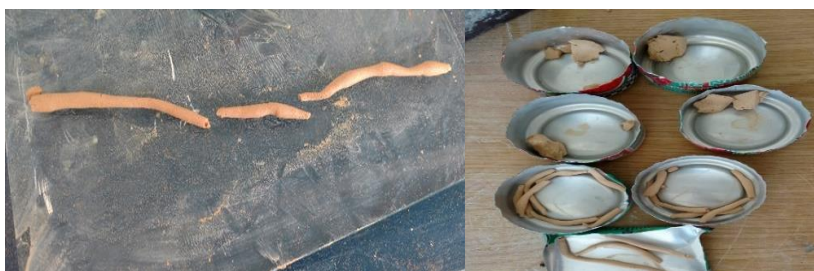
Fig. 3.11. Material en forma de cilindros de 3 mm y material secado en horno.
