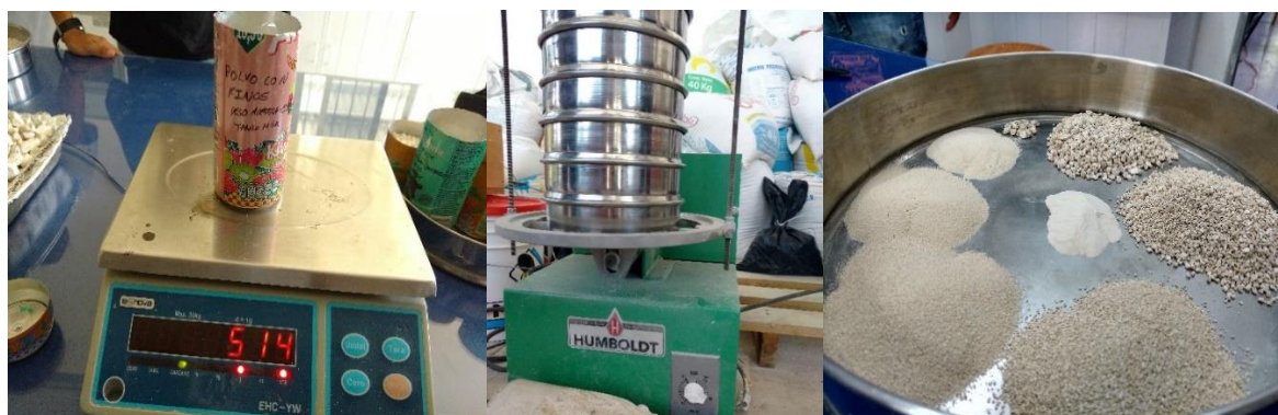
Fig.3.2. Determinación de la muestra, paso de la muestra por los tamices y granulometría de la arena.
