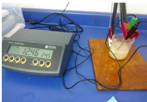
Fig. 3.12. Medición del pH con el HI 2211 Ph/ORP Meter del sascab.
