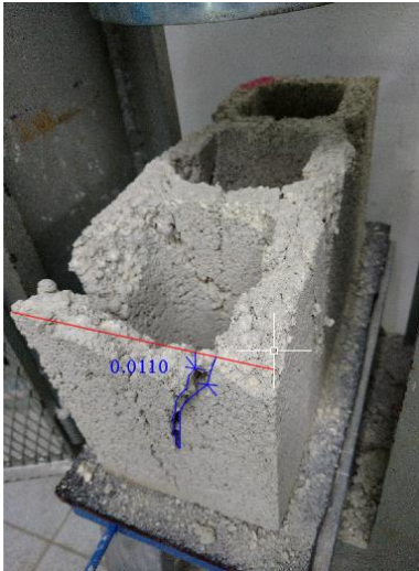
Bloque 5% de PET N°1 Fractura: Longitudinal en medio del bloque, separación de 1.1
