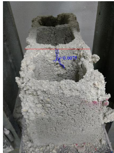
Bloque 5% de PET N°3 Fractura: Longitudinal en medio del bloque, Separación de 7.5 mm.
