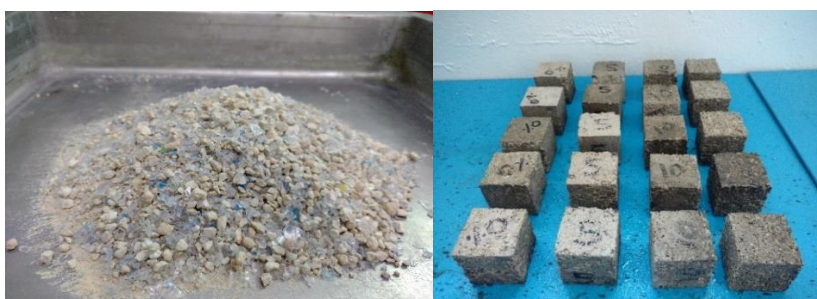
Fig. 3.22. Mezcla de los materiales y elaboración de cubos con sus porcentajes de PET.
