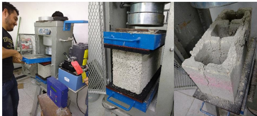
Fig. 4.2. Colocación de las placas para aplicación de la prueba de compresión.
