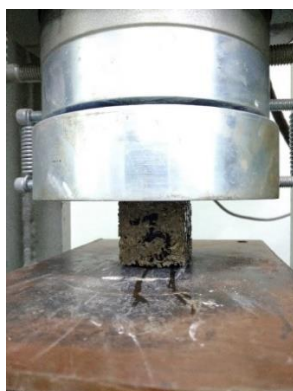
Fig. 3.26. Prueba a compresión de la proporción 1:3:2:3.
