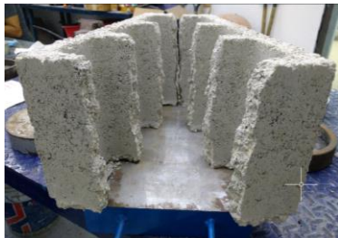
Bloque Triblok N°4 Fractura: Separado completamente por la mitad.
