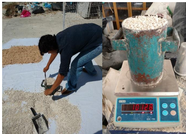
Fig. 3.19. Enrasado del material y registro del peso de la gravilla.
