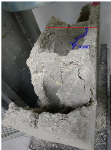
Bloque 5% de PET N°2 Fractura: Separación de 8.7 mm.
