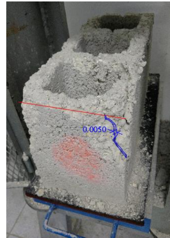
Bloque 10% de PET N°3 Fractura: separación de 5 mm.
