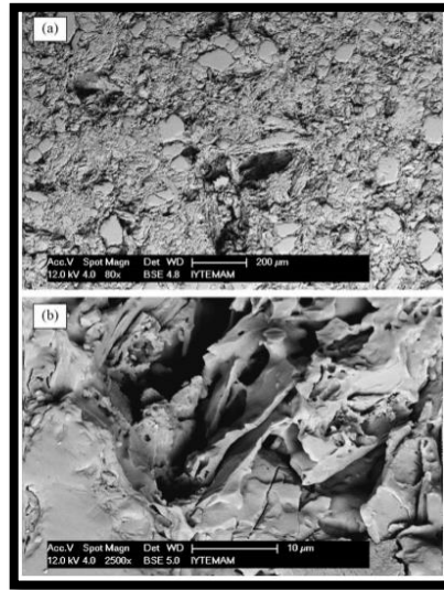
Fig. 1.4. SEM del ladrillo cocido sin residuo de papel reciclado. Fuente: (Sutcu & Akkurt, 2009).
