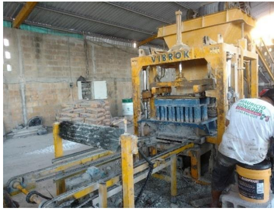
Fig. 2.16. Maquina vibro compactadora marca vibrok utilizada en la elaboración de bloques.
