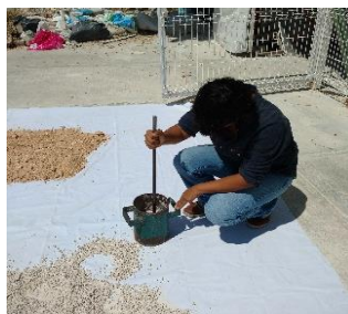
Fig. 3.20. Compactado de la gravilla con varillado.
