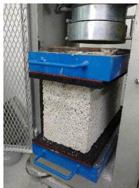
Fig. 2.17. Bloque en prensa con manómetro digital ADMET GB2.
