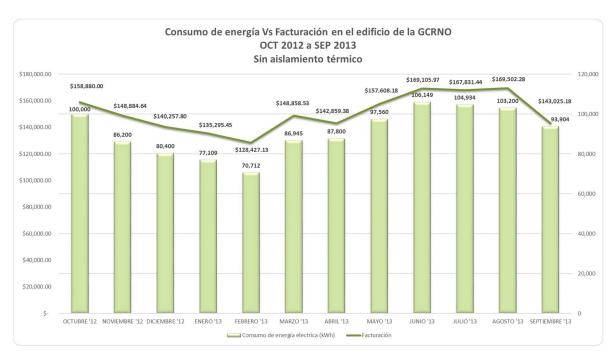
Gráfica 4.1.- Consumo de energía Vs Facturación en el edificio de la GCRNO antes del aislamiento.
