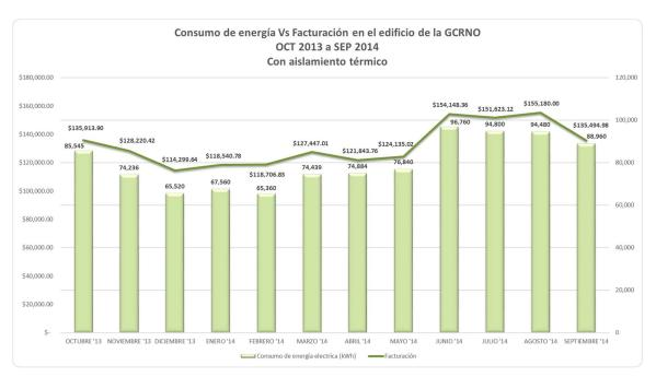
Gráfica 4.2.- Consumo de energía Vs Facturación en el edificio de la GCRNO después del aislamiento.
