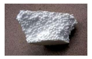
Ilustración 2.3.- El poliestireno expandido (EPS)
