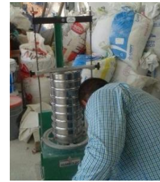
Agregado fino dentro del agitador
