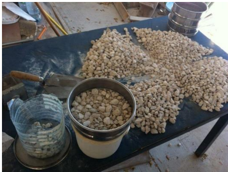
Cuarteo según la norma ASTM C702
