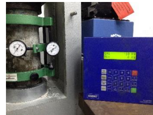
Prueba de módulo elasticidad 0.7
