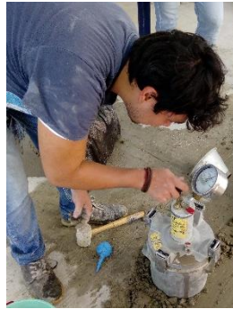
Prueba de aire relación a/c 0.6
