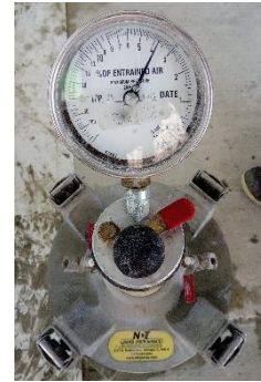
Prueba de aire relación a/c 0.6
