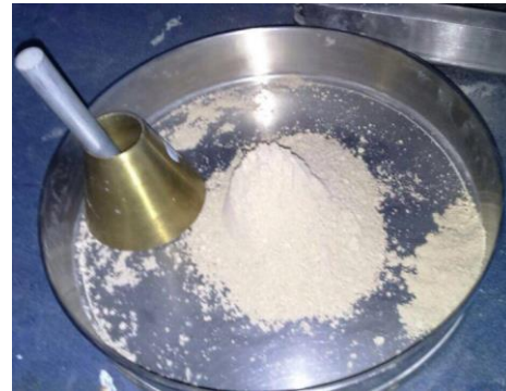
Desplome del agregado fino
