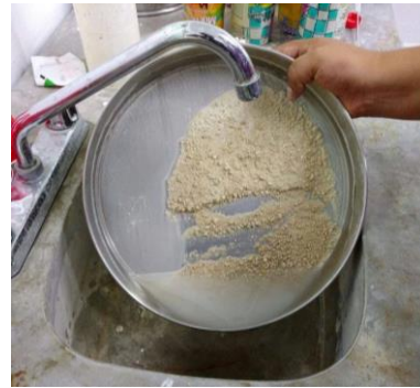
Decantar el agua evitando la pérdida de finos.
