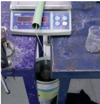
Pesaje de probetas sumergidas después de hervir
