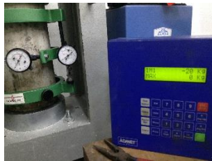
Prueba de módulo elasticidad 0.7
