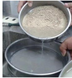
Lavado del material
