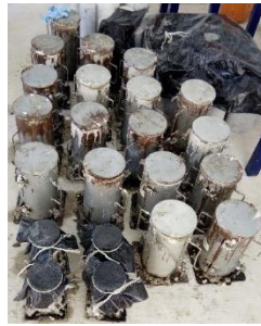
Figura 27.- Colado de cilindros
