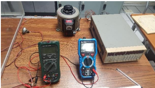
Figura 3.24 Mecanismos de lectura, multímetros, Variac y monitor de termopar
