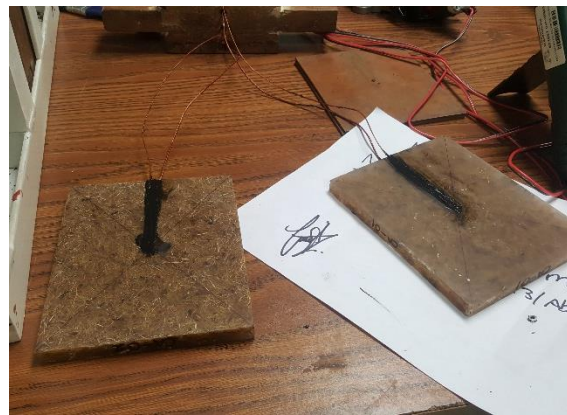
Figura 3.22 Colocación de termopar, sellado con silicón alta temperatura
