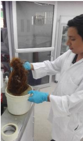
Figura 3.5 Tratamiento alcalino de fibras
