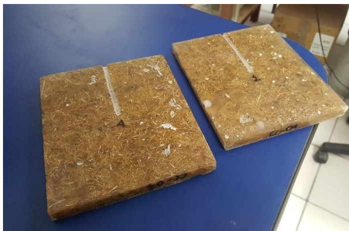
Figura 3.20 Ranuras en probeta para recibir termopares
