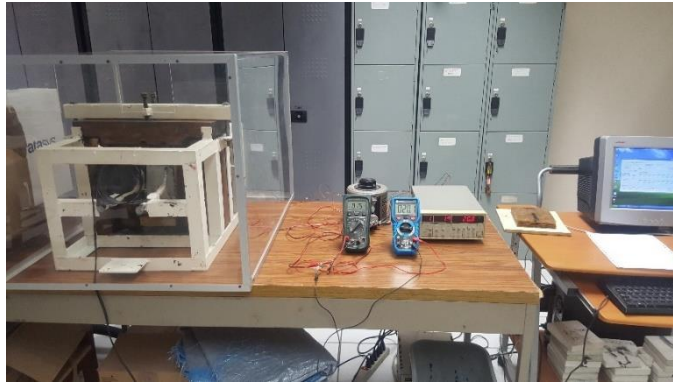
Figura 3.19 Conductímetro de placa caliente con guarda
