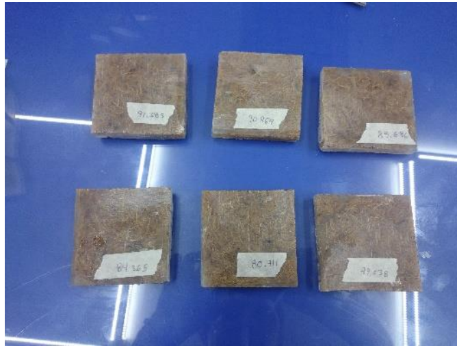
Figura 3.15 Probetas de ensayo Densidad/Absorción
