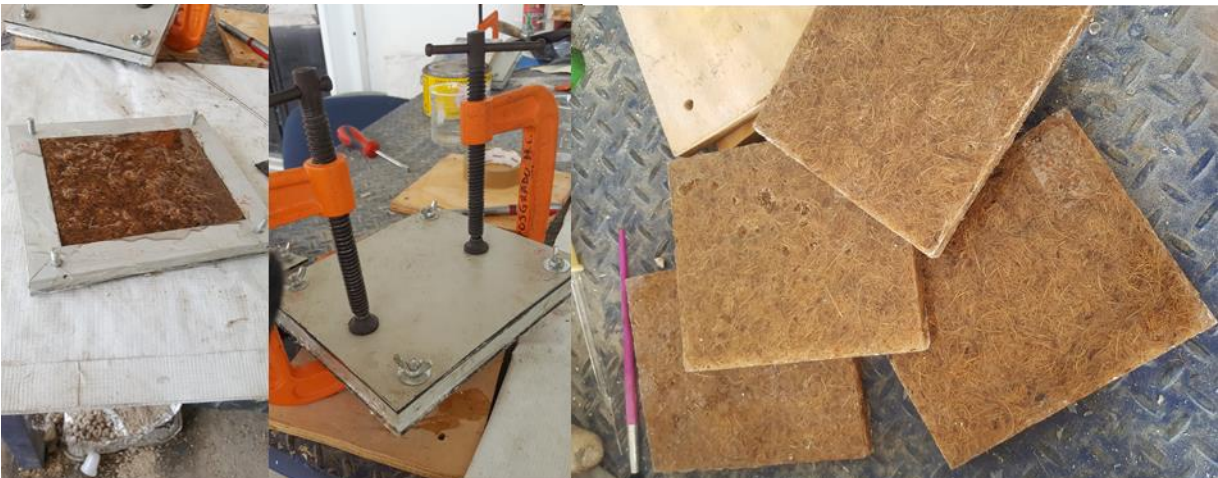
Figura 3.14 Proceso de consolidación y solidificación de moldeo manual
