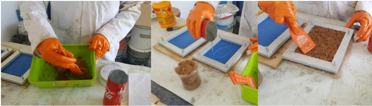
Figura 3.13 Proceso de impregnación y estratificación de moldeo manual
