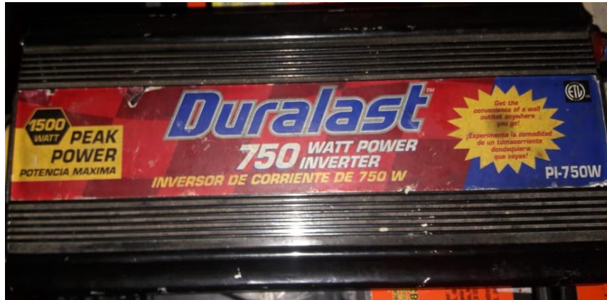
Ilustración 10 Inversor de corriente
