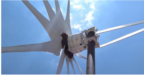
Ilustración 3 Soporte y Alternador del generador.
