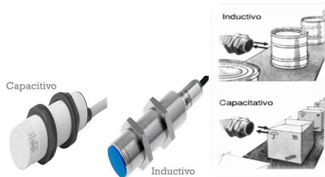
Ilustración 31 Detector Inductivo y Capacitivo.
