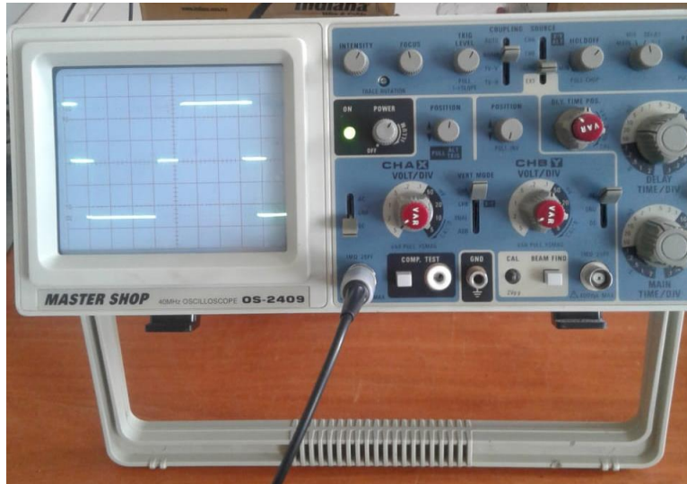
Ilustración 14 Voltaje de salida del inversor de 120-127 volts.
