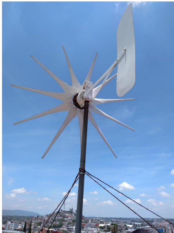
Ilustración 4 Soporte, Veleta y Torre de Generador.
