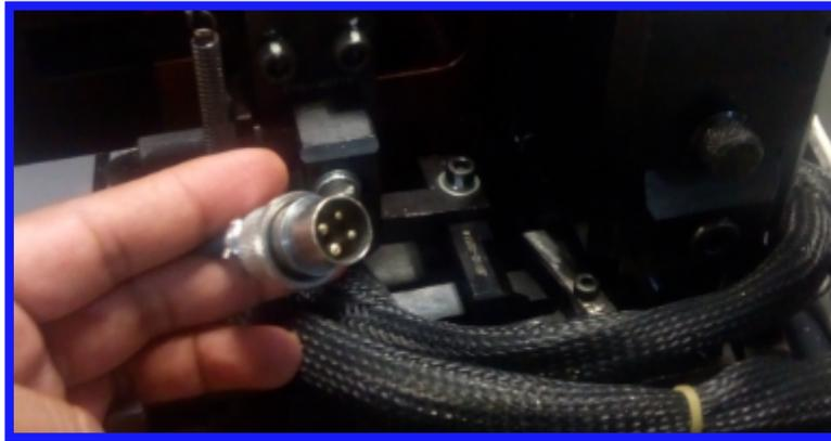
3.- Al mandar la señal eléctrica a la bobina el embolo o vástago activa la electro válvula para los cambios de entrada y salida de aire al pistón el cual tiene una entrada para la toma de aire que va directo a la maquina, el pistón al momento de ser activado impulsa la leva que es la guía del dedo de avance para alimentar la terminal al momento de ser prensada
