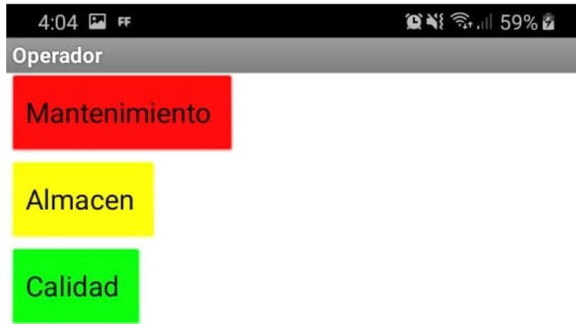
Figura 14 Interfaz luces del sistema andon
