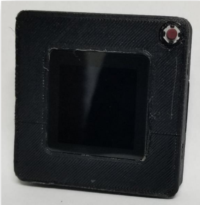
Figura 4.7. Fabricación del chasis en 3D
