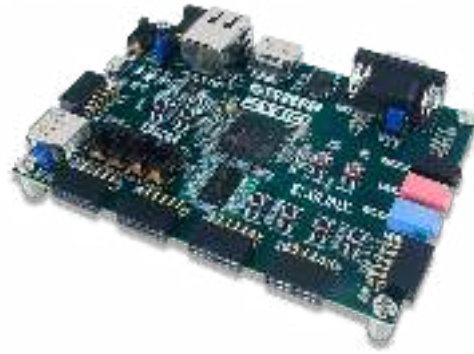
Figura 3.1: SoC Xilinx Zynq-7000 empleado para este proyecto.
