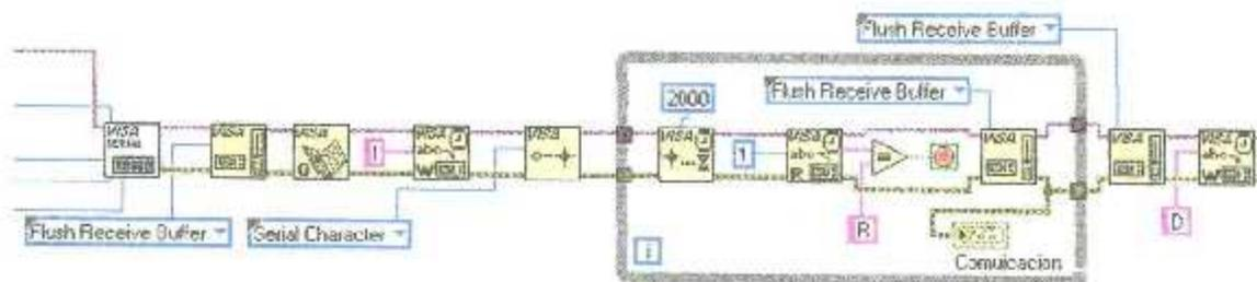
Figura 3-9 VI's Para establecer la comunicación con el microcontrolador.
