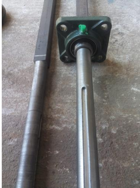
Figura 4.5. Extremo del eje de sujeción donde irá sujeta la chumacera.
