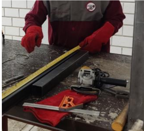
Figura 3.15. Obtención de las medidas de las piezas a cortar.
