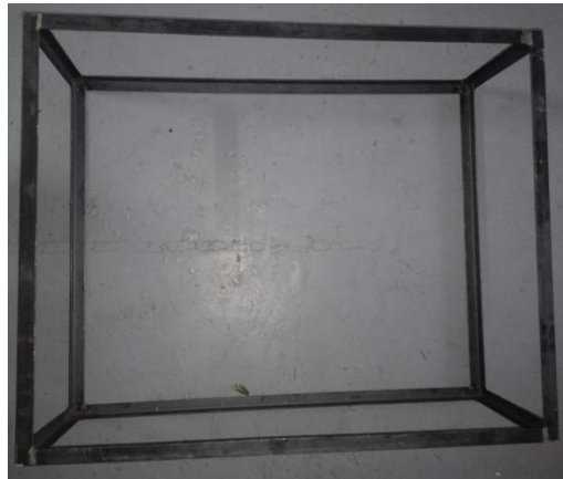
Figura 3.21. Estructura del cernidor terminada.
