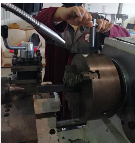
Figura 3.30. Centrado y sujeción del eje.
