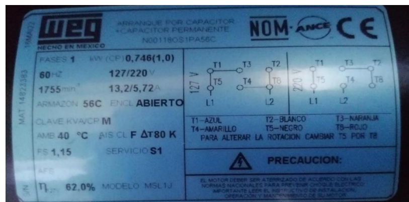
Figura 3.38. Placa de características de un motor.
