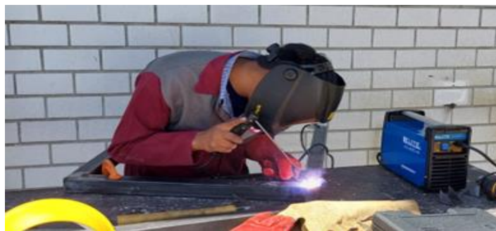
Figura 3.6. Proceso de soldadura de las piezas de la estructura inferior.
