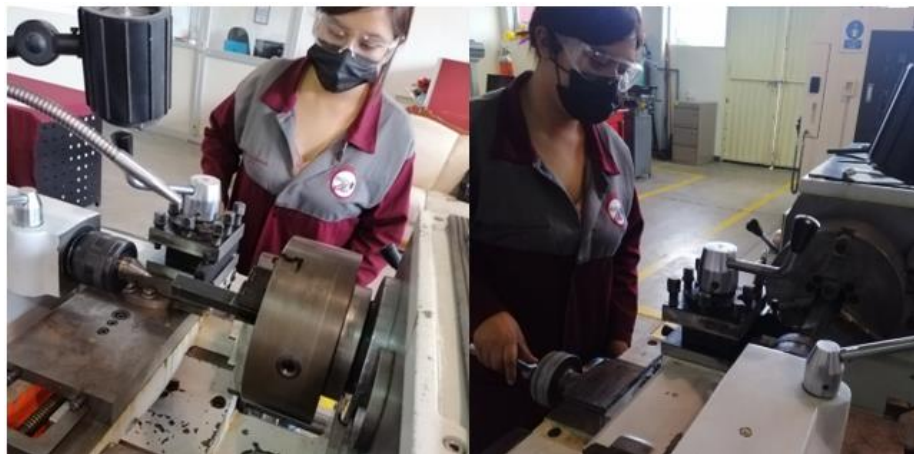
Figura 3.33 Torneado del eje de sujeción.
