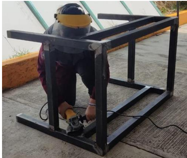
Figura 3.9. Proceso de esmerilado con disco de piedra en las esquinas inferiores.
