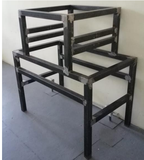
Figura 4.1. Estructura final de la máquina desterradora-cernidora.
