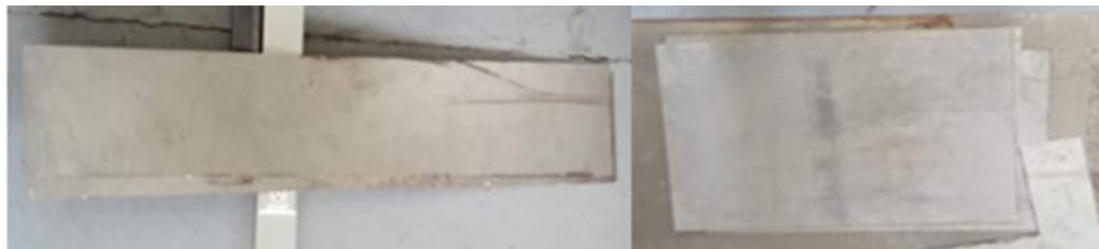
Figura 4.6. Lámina de calibre 18 cortada a medida de las caras de la estructura principal.
