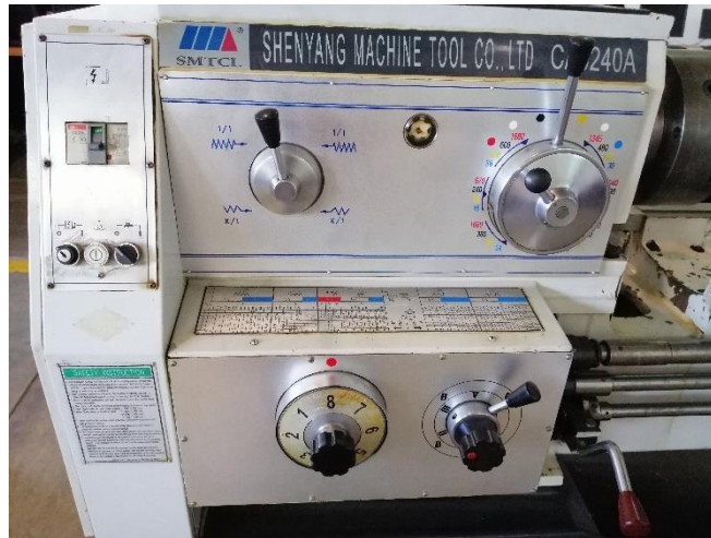
Figura 3.32. Palancas de velocidades y sentido de giro del Chuck.
