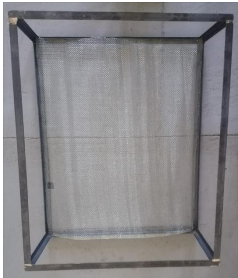
Figura 4.3. Estructura final del cernidor con malla remachada.
