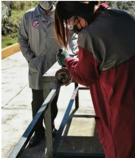
Figura 3.27. Corte de material al largo requerido.
