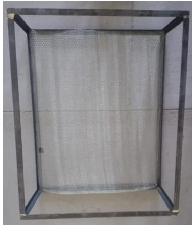
Figura 3.24. Malla remachada en la estructura del cernidor.
