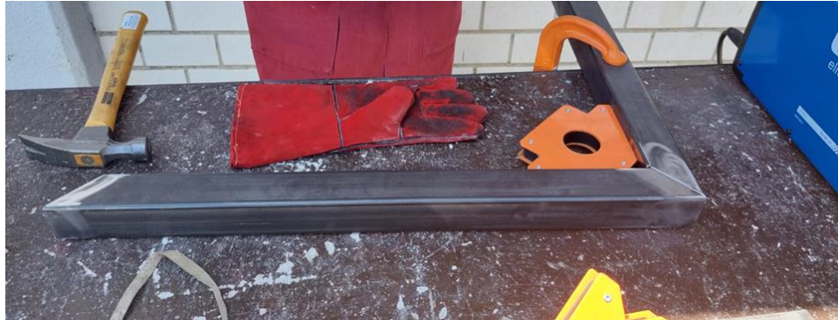
Figura 3.5. Escuadreado de las piezas de la base principal a los ángulos requeridos.
