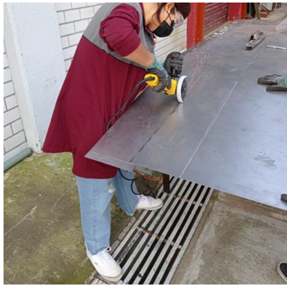
Figura 3.35. Corte de lámina con esmeriladora.
