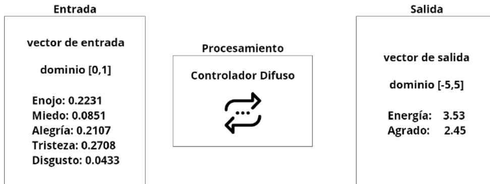
Figura 4.17: Proceso general del sistema controlador difuso.
