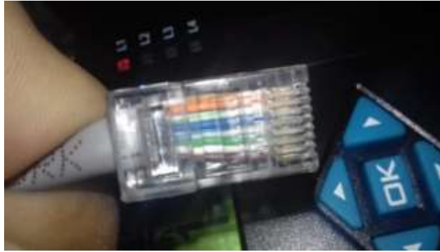
Figura: 45; Cable Ethernet utilizado para la comunicación Puerto COM 1, terminal RJ-45.
