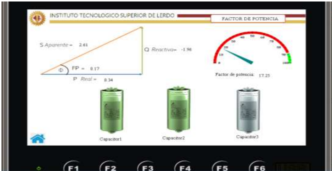
Figura: 128; Pantalla HMI “01FACTOR FE POTENCIA” en simulación, capacitor 2 energizado.
