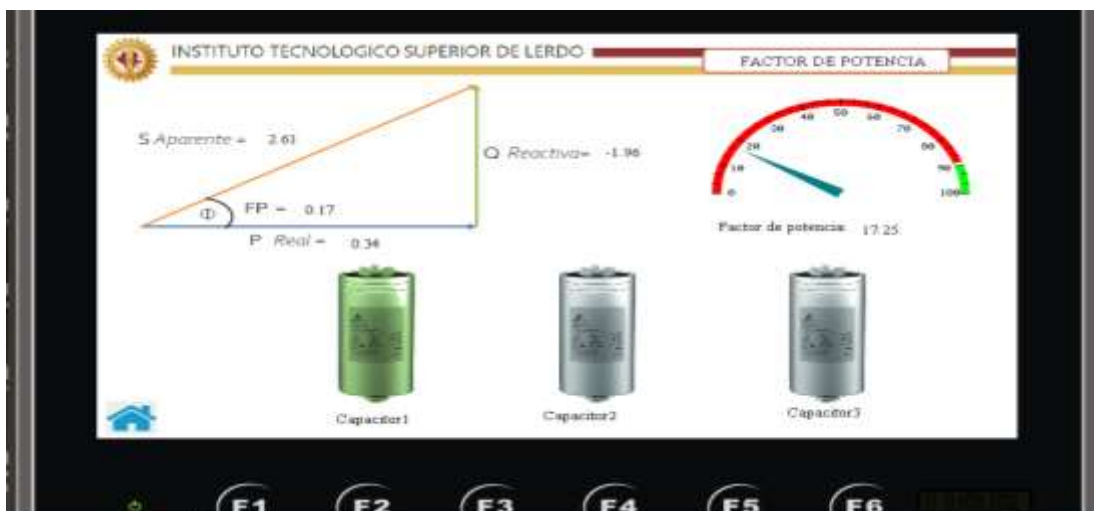
Figura: 127; Pantalla HMI “01 FACTOR DE POTENCIA” en simulación, capacitor 1 energizado.
