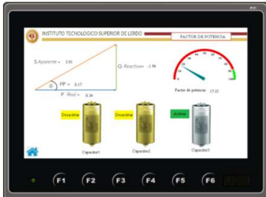
Figura: 135; Pantalla HMI “01 Factor de Potencia” de simulación, capacitor #2 accionado manualmente.
