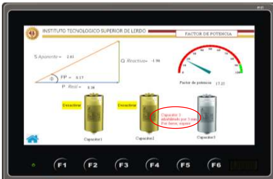
Figura: 137; Pantalla HMI “01 Factor de Potencia” de simulación, capacitor #3 Desactivado manualmente.
