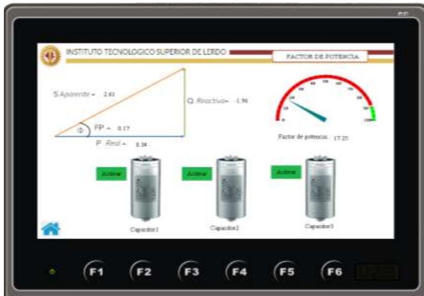
Figura: 133; Pantalla HMI “01 Factor de Potencia” de simulación, los 3 capacitores listos para activarse de modo Manual.
