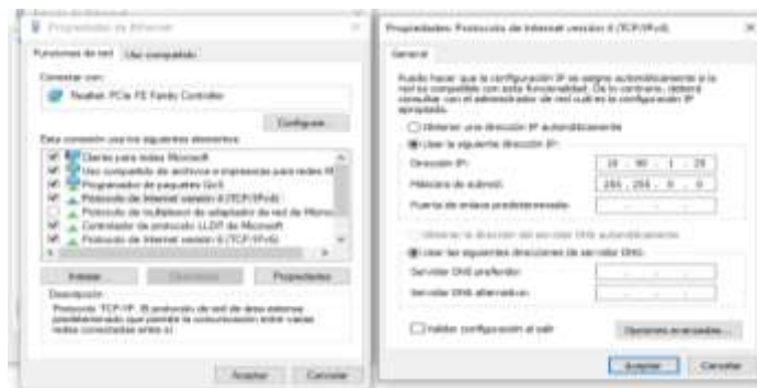
Figura: 46; Configuración de la IP del PLC en versión V4.
