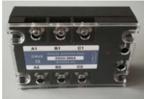
Figura: 40; Relevador trifásico de estado sólido CHUX ZG33-380 a .
