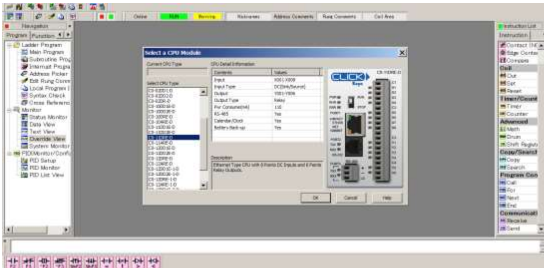
Figura: 52; Selección del módulo CPU del plc.
