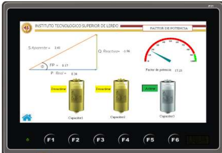
Figura: 138; Pantalla HMI "01 Factor de Potencia" de simulación, capacitor #3 Desactivado manualmente.
