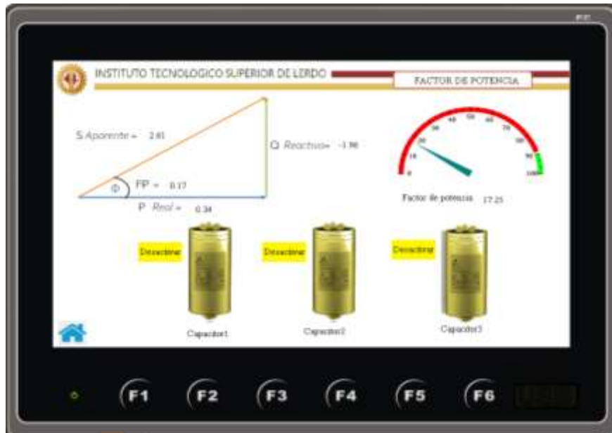
Figura: 136; Pantalla HMI “01 Factor de Potencia” de simulación, capacitor #3 accionado manualmente.
