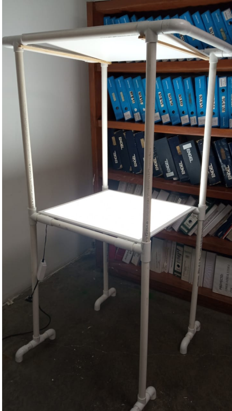
Figura 3.3: Estructura para la toma de imágenes.
