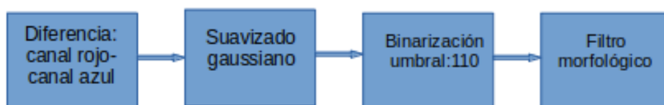
Figura 3.39: Procesamiento de la cara superior para manchas y hueco.
