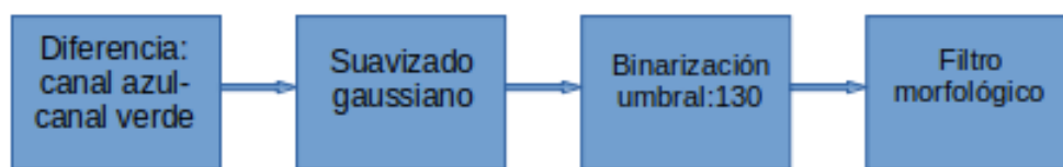
Figura 3.38: Procesamiento de la cara superior para rebaba.
