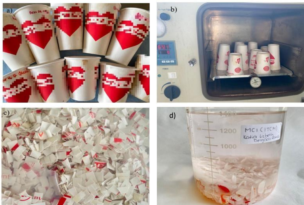
Figura 5.3. Imágenes de los vasos a) lavado, b) en proceso de secado, c) cortado y d) separación fibra de celulosa del polietileno.
