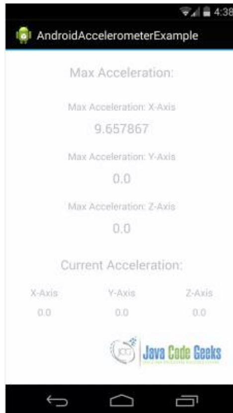
Figura 41. . Pantalla de ejemplo de Acelerómetro de Aliferi, con métrica de valor para Eje X. (Dispositivo móvil en posición horizontal). Fuente: Aliferi, 2014.
