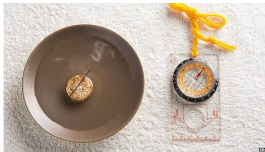
Figura 1. Brújulas casera y convencional. Fuente: BBCNews Mundo Tecnología, 2015.
