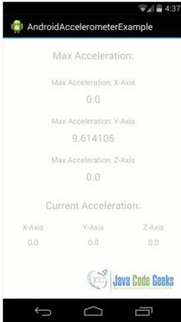
Figura 40. . Pantalla de ejemplo de Acelerómetro de Aliferi, con métrica de valor para Eje Y. (Dispositivo móvil en posición vertical). Fuente: Aliferi, 2014.
