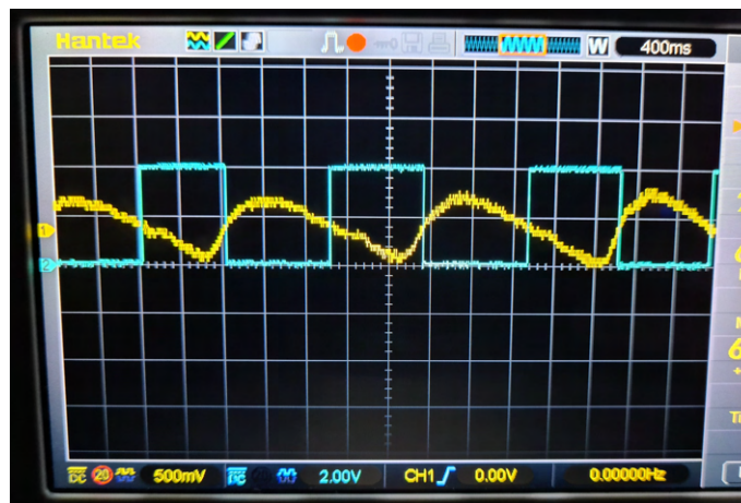
Figura 4.14: Señales de salida de la Etapa IV. En amarillo la señal en la base del transistor y en azul la salida en el colector.
