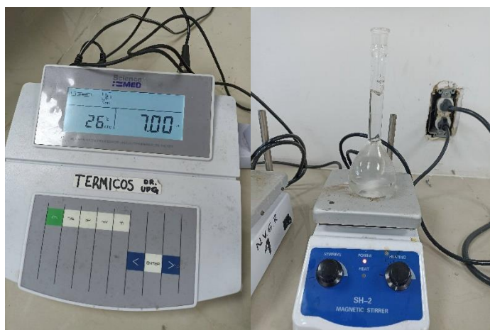
Figura 21. Medición de pH y agitación de muestra
