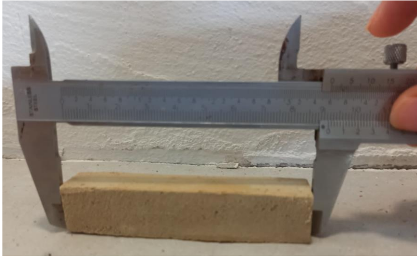
Figura 4.8. Medición del bloque final para la determinar de la contracción lineal.
