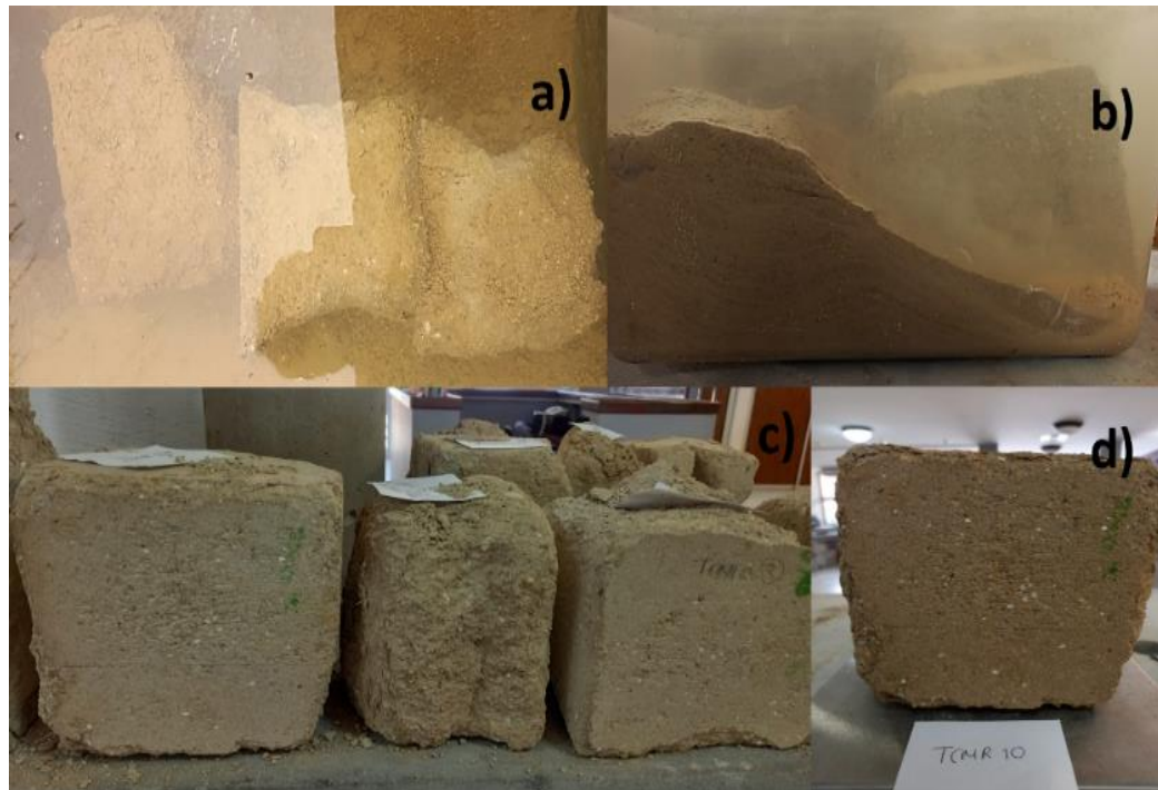
Figura 5.19. Proceso de prueba de absorción de agua durante 24 horas.
