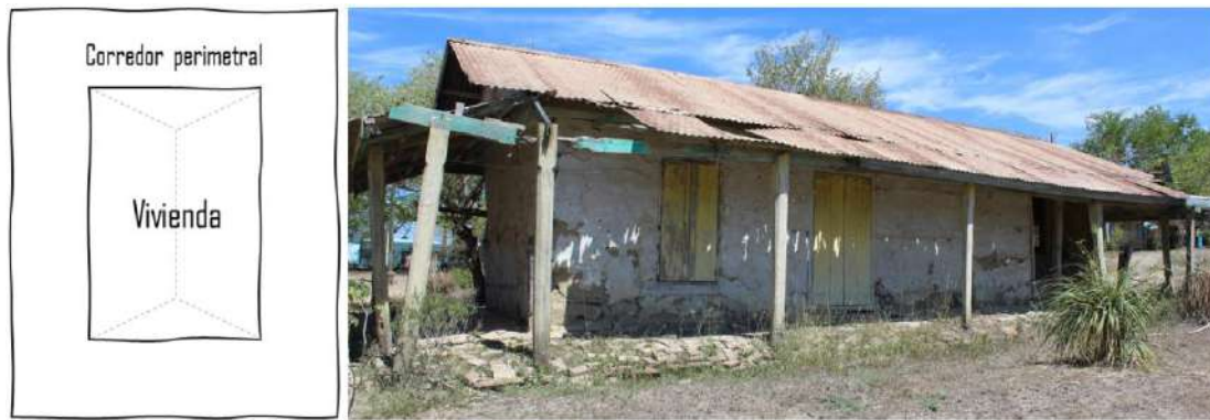
Figura 13. Diagrama básico y ejemplo de vivienda con pasillo perimetral.
