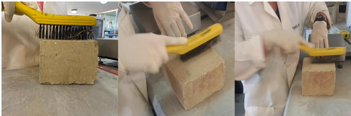
Figura 5.16. Proceso de prueba de abrasión, donde se determinó el coeficiente de resistencia a la abrasión de los BTC.
