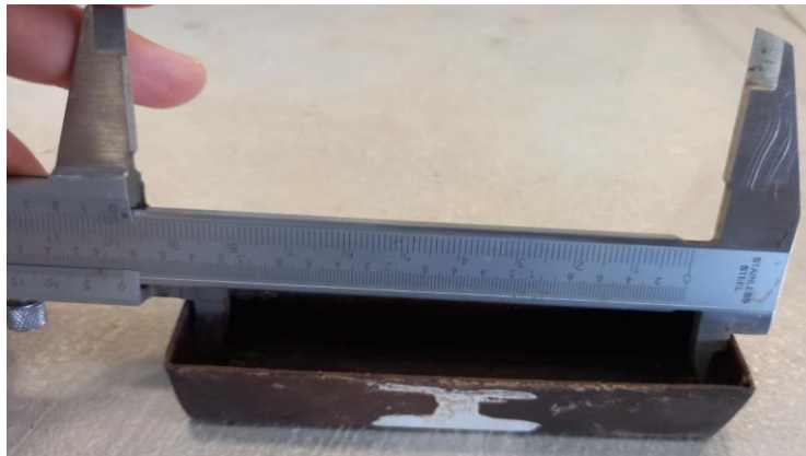
Figura 4.6. Medición del molde para determinar el límite de contracción.
