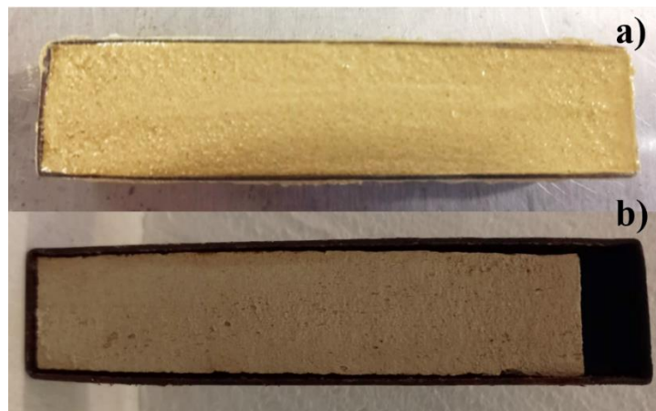
Figura 4.7. En el (a) vaciado del material con la muestra límite líquido y (b) límite de contracción.
