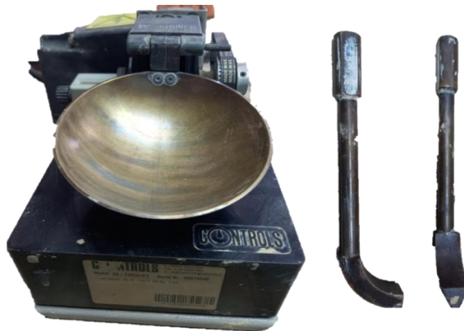
Figura 4.4. Cuchara Casagrande y el acanalador con el que se determina el límite líquido.
