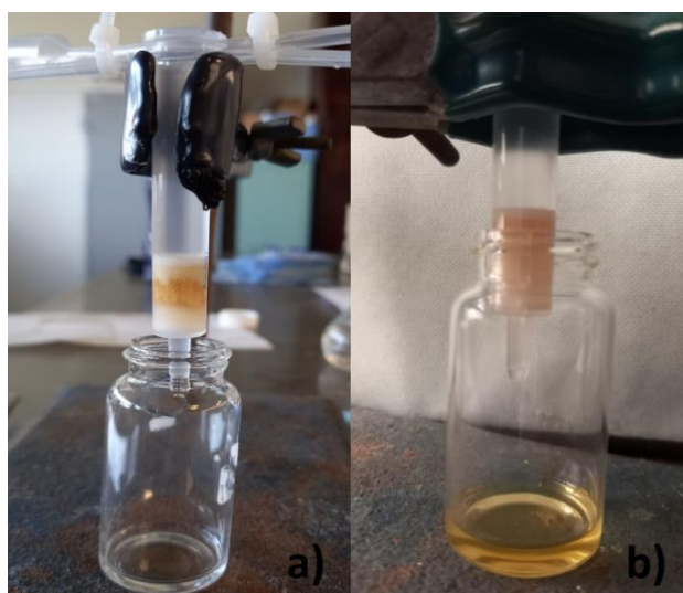
Figura 5.3. Purificación de fenoles en tamiz molecular, (a) filtración del extracto y (d) el lavado con HCl 0.01%.
