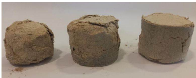
Figura 5.29. Estado físico de los núcleos de tierra después de las pruebas de remoción de cloruros.
