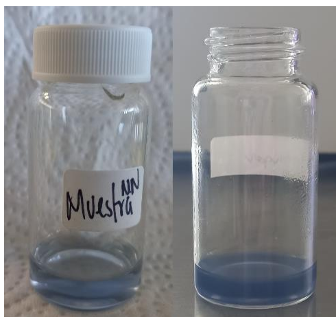
Figura 5.5. Fenoles del mucílago de nopal, determinados por colorimetría por método de Folin Denis-Ciocalteu.
