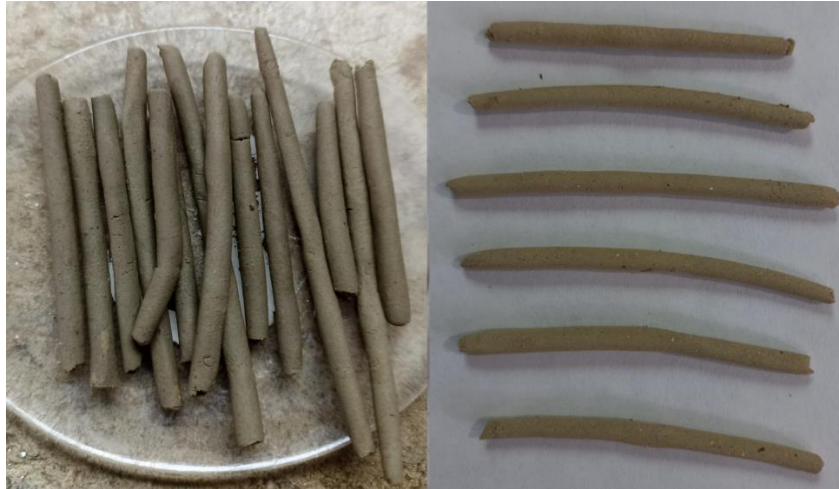
Figura 4.5. Bastones formados para determinar el límite plástico.
