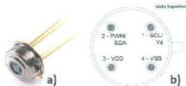
Figura 2.21 Sensor de temperatura MXL90614. a) Aspecto, b) configuración de terminales.
