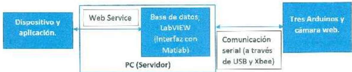
Figura 3.2 Tecnologías de comunicación entre los bloques y sus elementos.
