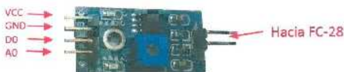
Figura 2.24 Configuración de terminales del módulo YL-38.
