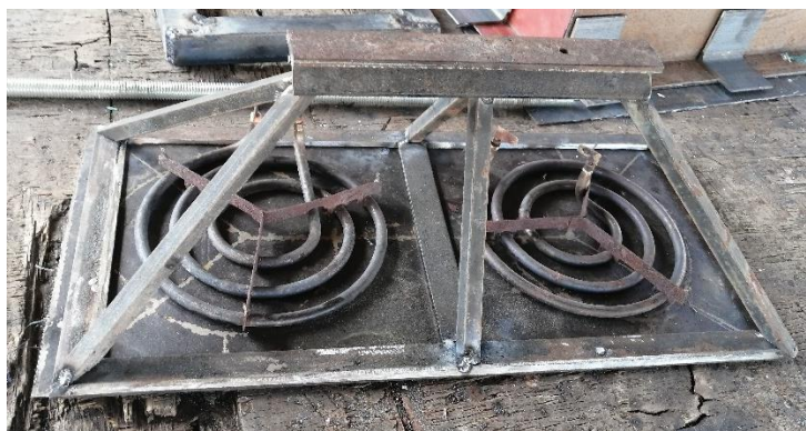
Figura 8. Tapa del molde con las resistencias presentadas. Fuente: Propia del autor (2021).
