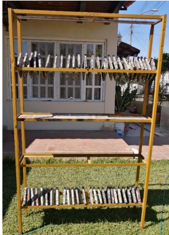
Figura 32. Base de aluminio con los paneles colocados. Fuente: Propia del autor (2021).
