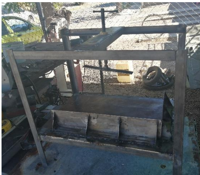
Figura 12. Tornillo colocado en la parte superior de la máquina, en la parte inferior, la mitad del molde soldado. Fuente: Propia del autor (2021).
