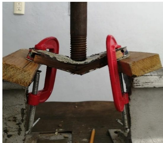
Figura 35. Probeta AGI siendo ensayada. Fuente: Propia del autor (2021).
