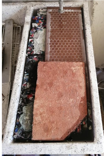
Figura 31. Peso colocado encima a los paneles para evitar que flotarían. Fuente: Propia del autor (2021).
