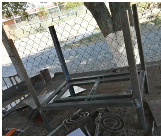
Figura 7. Base de la maquina hecha de ángulos de hierro. Fuente: Propia del autor (2021).
