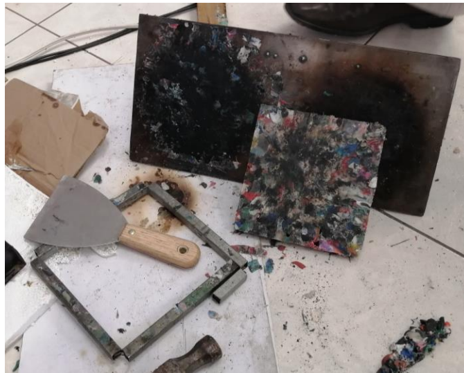
Figura 27. Panel recién desmoldado. Fuente: Propia del autor (2021).
