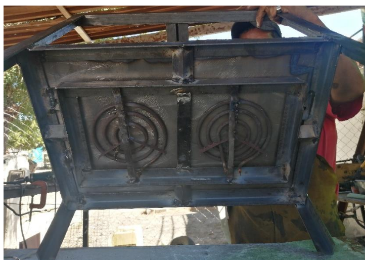
Figura 11. Resistencias colocadas en la base de la máquina. Fuente: Propia del autor (2021).
