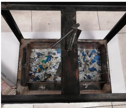
Figura 15. Plástico siendo derretido por la máquina. Fuente: Propia del autor (2021).
