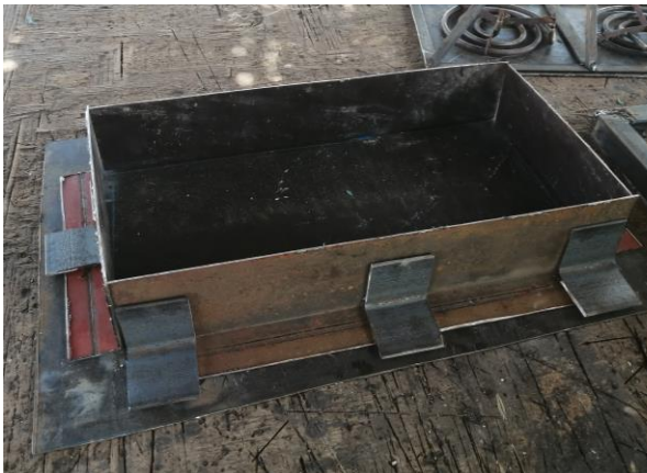
Figura 9. Molde presentado en la lámina de la base. Fuente: Propia del autor (2021).
