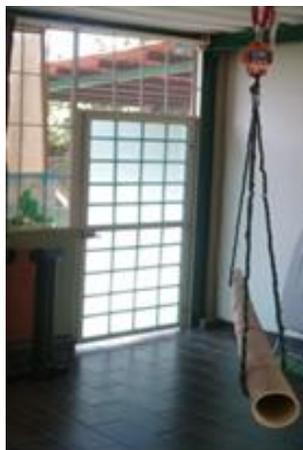
Figura 25. Obtención del peso, antes y después del proceso de secado.
