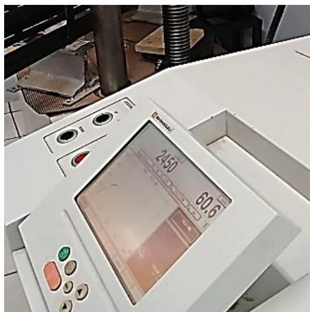
Figura 33. La pantalla muestra la carga y la deformación máxima: ensaye 3ME
