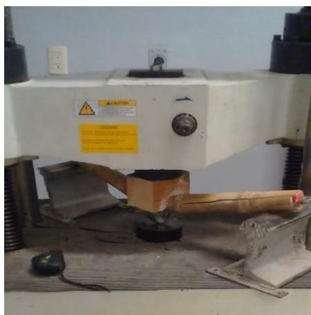
Figura 19. Viga con acero interior, culmo de bambú de  $\approx 2''$  de  $\varnothing$ .
