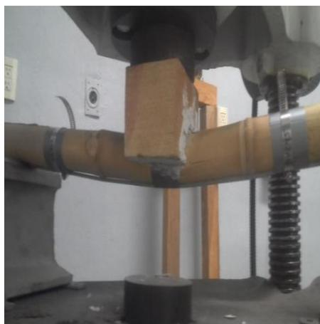
Figura 20. Culmo de bambú de  $\approx 2"$   $\varnothing$  con acero exterior.
