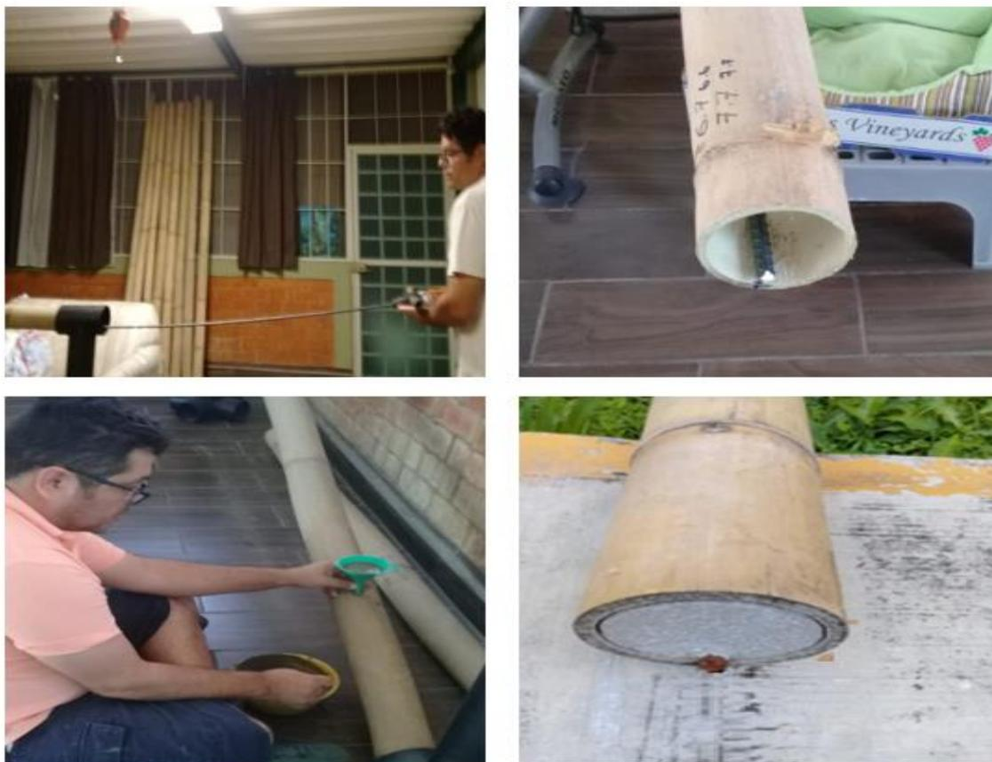
Figura 26a, b, c y d respectivamente. Fabricación de probeta con acero interior.
