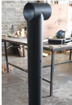
Figura 68. Fabricación de dos postes de apoyos para la viga.
