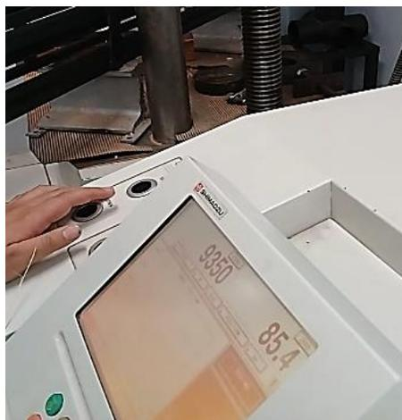
Figura 30. La pantalla muestra la carga y la deformación máxima: ensayo 1BI.
