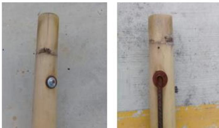
Figura 27a, vista superior y b, vista inferior respectivamente. Fabricación de probeta con acero exterior.
