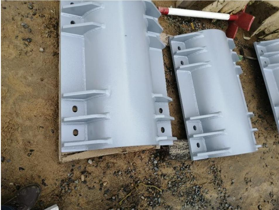
*Figura 34. Piezas con el sistema de recubrimiento anticorrosivo aplicado. Fuente: Propia*
