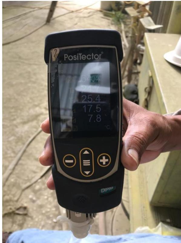
*Figura 38. Medidor de punto de rocío. Fuente: Propia.*
