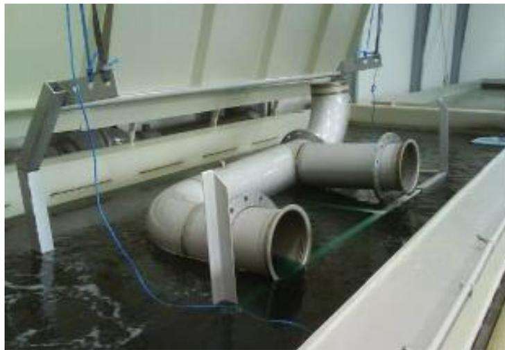
*Figura 8. SSPC-SP-8. Fuente: (CONSTRUCTORA OCITRIMEX, n.d.).*
