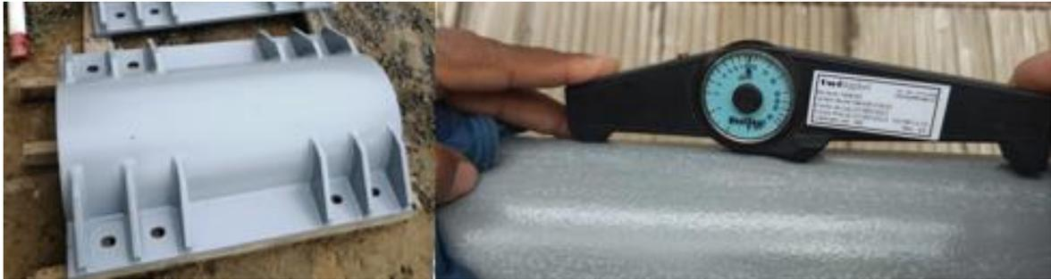
*Figura 39. Medidor de espesor en película seca de la pieza pintada. Fuente: Propia*
