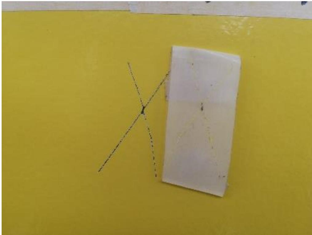
*Figura 40. Realización prueba de adherencia. Fuente: Propia.*
