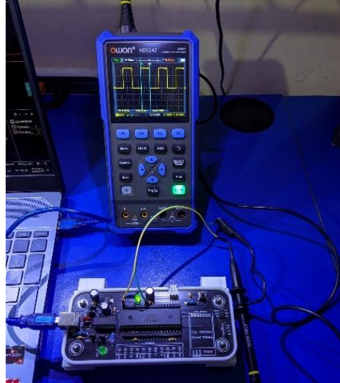
Figura 37 Banco de pruebas del sistema embebido.
