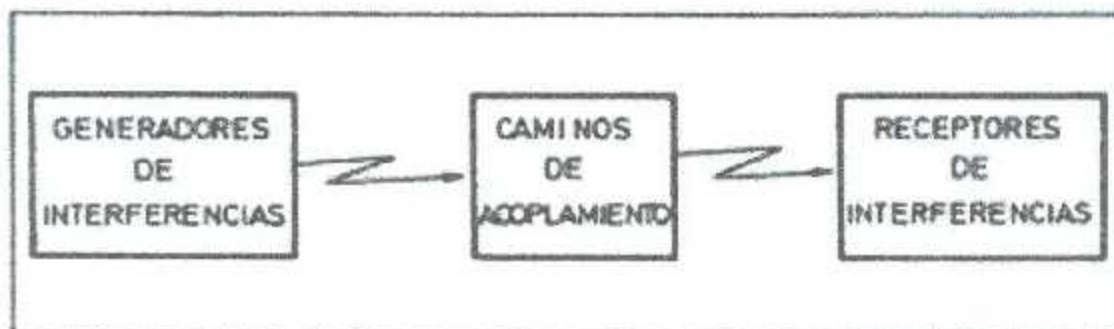
Figura 2.1 Partes principales en todo fenómeno de interferencia electromagnética. [3]
