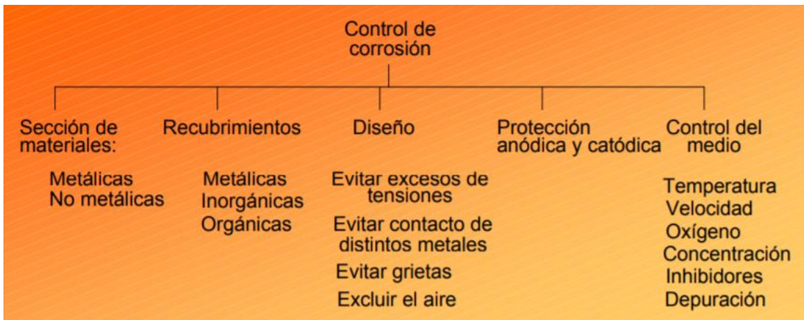
Figura 3.14. Métodos comunes de control de corrosión.
