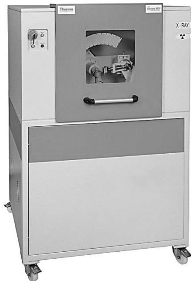
Figura 4.10. Difractómetro Inel, modelo EQUINOX 2000.
