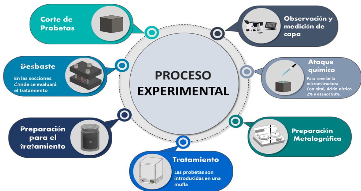
Figura 4.9. Proceso termoquímico de borurización.
