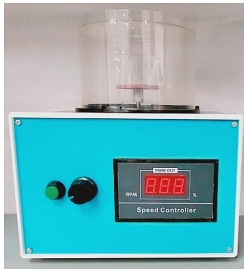
Ilustración 6 Equipo de spin-coating de bajo costo elaborado en el laboratorio de ingeniería de superficies del Instituto Tecnológico de Monterrey campus Estado de México.
