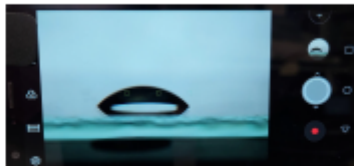
Fig. 4. Fotografía de una gota de agua para medir el ángulo de contacto
