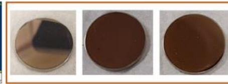
Figura 2. Sustratos de acero inoxidable 316L después de ser depositados con Ti/TiN por PVD.
