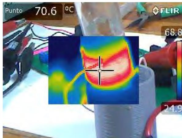
Figura 41. Temperatura en inductancia auxiliar capturada con la cámara termográfica a una frecuencia de 400 kHz.
