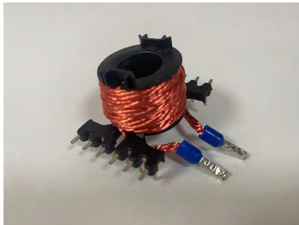
Figura 23. Inductancia auxiliar agregada al circuito.
