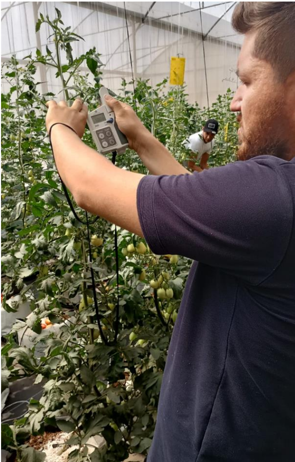
Figura 18. Medición de clorofila de la 5ta hoja a partir del ápice.
