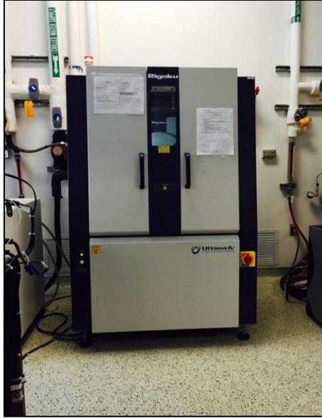
Figura C.3.2 Difractómetro Rigaku Ultima IV.
