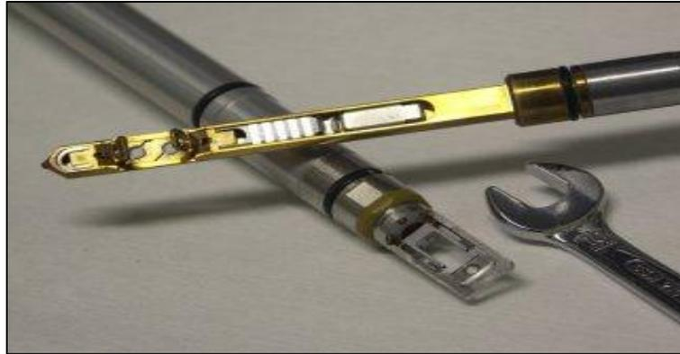
Figura C.4.3 Porta muestra utilizado en un microscopio TEM. <sup>[96]</sup>
