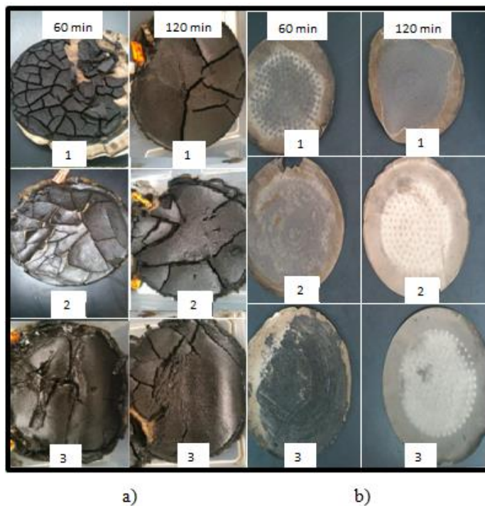
Figura 3.2 a) Mezcla de lignina residual y cenizas y b) cenizas de cada muestra a 200 °C y a 60 y 120 min
