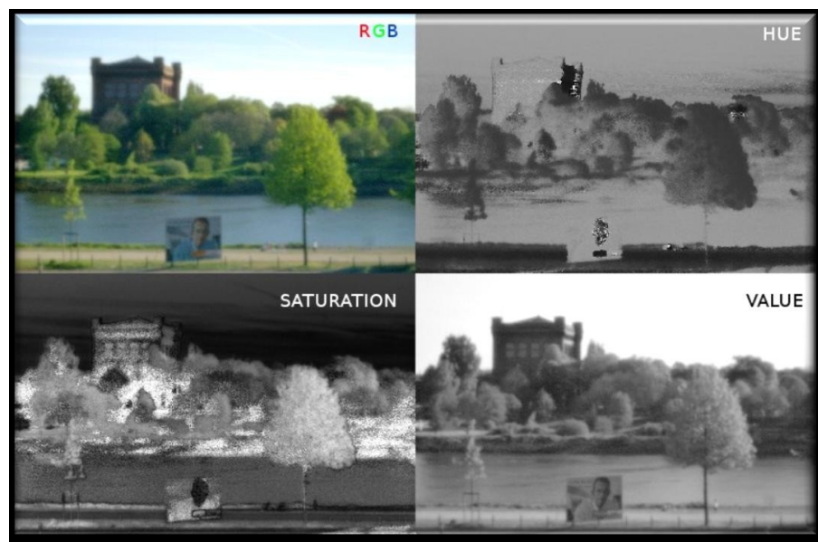
Ilustración 13. Conversión de colores RGB a HSB. Se pueden apreciar los diferentes valores del modelo HSB, Hue (Matiz), Saturation (Saturación), Brightness (Brillo).
