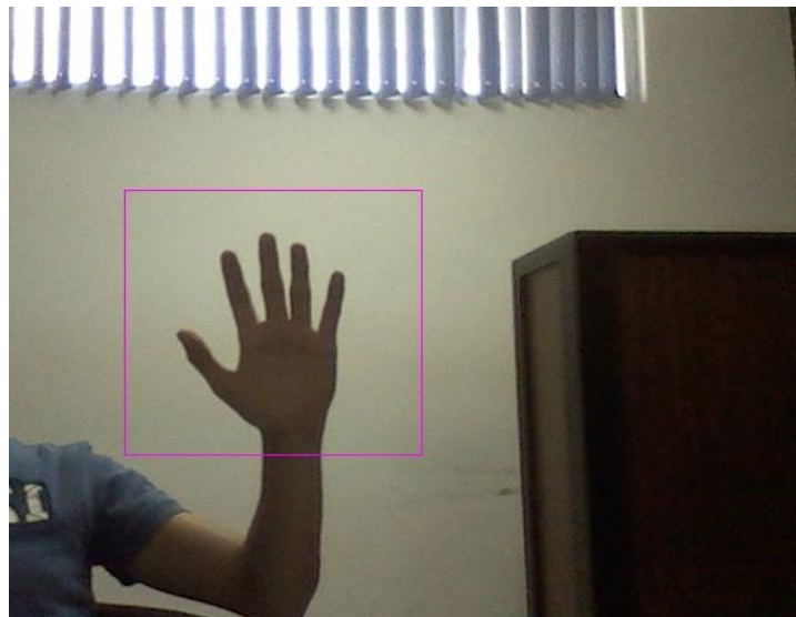
Ilustración 20. Captura del Detector de Viola-Jones. La imagen muestra la detección realizada por el detector de Viola-Jones, enmarcada por el programa con un cuadro color violeta.
