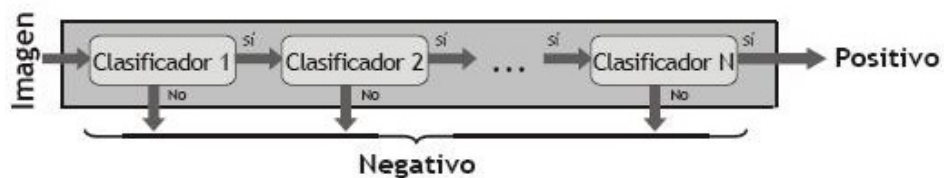
Figura 11. Descripción esquemática de una cascada de detectores. Una serie de clasificadores son aplicados a cada imagen, el clasificador inicial elimina un gran número de sub-ventanas negativas de la imagen con muy poco procesamiento. Los clasificadores siguientes eliminan sub-ventanas negativas adicionales de la imagen pero requieren cálculos más complicados. Después de varias etapas de clasificación el número de sub-ventanas es reducido hasta obtener un área positiva de la imagen que es donde se encuentra el objeto que se busca.
