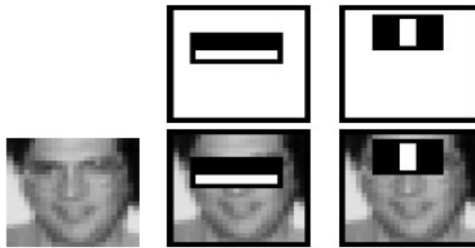
Figura 10 Filtros aplicados a una imagen, las operaciones se realizan en los niveles de intensidad de los píxeles abarcados por cada filtro, en el caso de la imagen del centro, a las regiones de los ojos y las mejillas, a la imagen de lado izquierdo, a las regiones de los ojos y la nariz.
