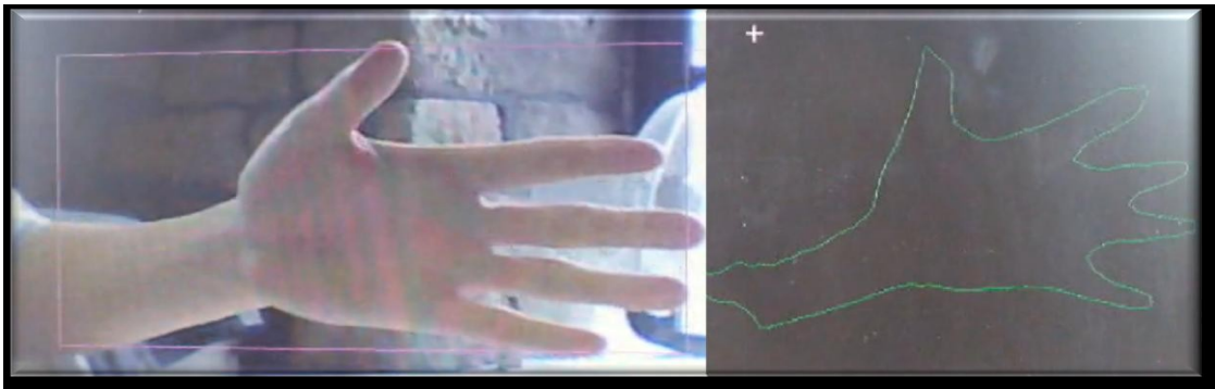
figura 8. Se puede observar en la parte derecha de la imagen el contorno obtenido de la región donde se determina que se encuentra la mano, la parte izquierda muestra la detección de la mano hecha por el programa.
