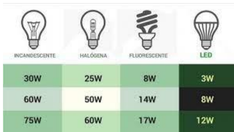
Figura 14.- Comparativa del consumo eléctrico en las diferentes tecnologías de iluminación.
