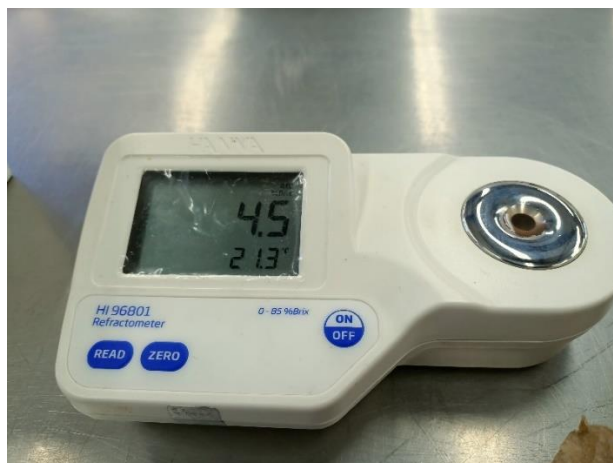
Figura 23.- Medidor de grados Brix con una muestra de jugo del tomate cosechado.
