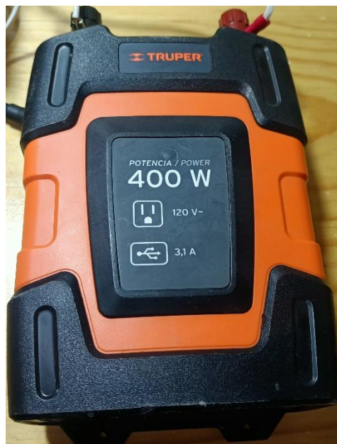
Figura 30.- Inversor de corriente para el SFV.
