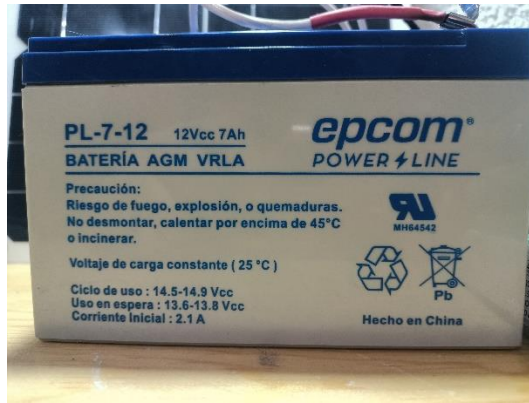
Figura 29.- Batería para el sistema fotovoltaico.
