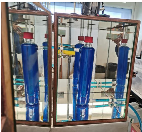
Figura 2.5 Dispositivo empleado para medir la actividad fotocatalítica con luz UV.
