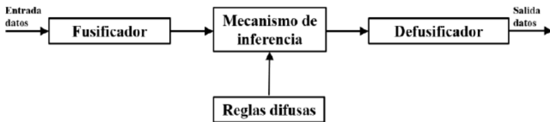
Figura 11. Diagrama de proceso de inferencia en sistema difuso
