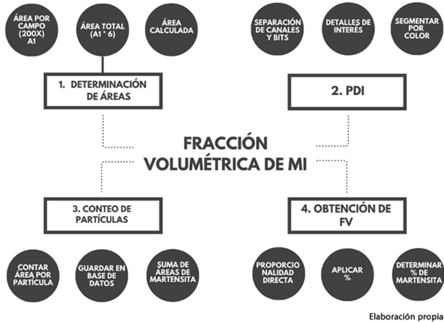
Figura 3.13 Mapa mental de la metodología para obtener la fracción volumétrica y porcentaje de martensita intergranular de uniones soldadas robotizadas GTAW-P en acero inoxidable ferrítico AISI 430 sin metal de aporte. Elaboración propia ®
