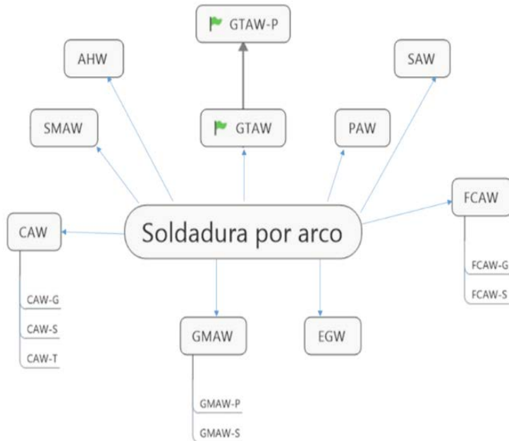
Figura 2.11 Técnicas de soldadura por arco eléctrico como mapa mental. Elaboración propia.
