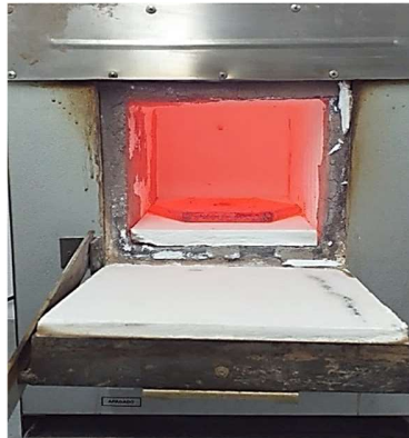
Figura 8.25. Tratamiento termoquímico de borurización de la hoja de sierra circular a la temperatura de 1223 K y un tiempo de tratamiento de 6 h.
