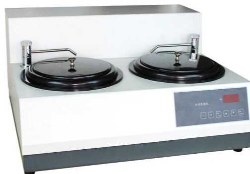
Figura 5.5. Pulidora Phoenix Beta empleada para darle un acabado espejo a las probetas endurecidas.
