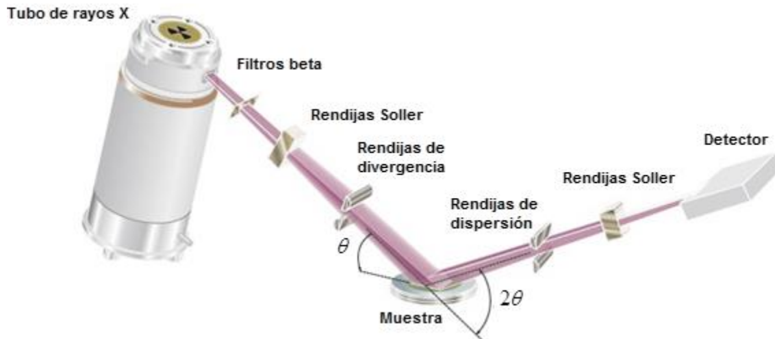
Figura 5.10. Esquematización del funcionamiento de un difractor de rayos X.
