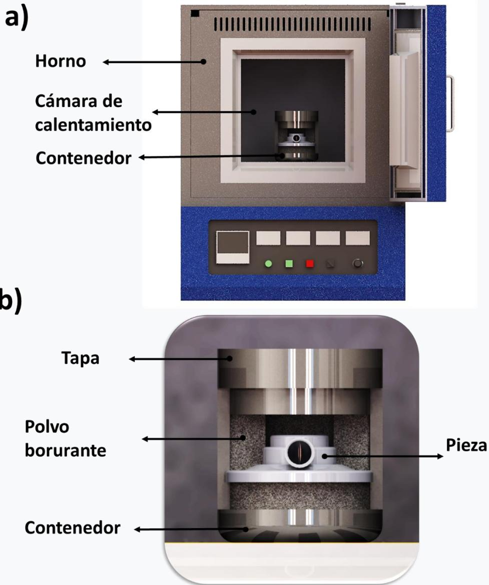
**Figura II.2** Representación del tratamiento de borurización: a) horno tipo mufla con contenedor sellado en la cámara de calentamiento, b) contenedor sellado con la pieza embebida en el polvo borurante.
