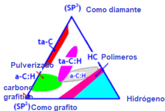
Figura 2.2 Diagrama de fase ternario de revestimientos de carbono amorfo [14].
