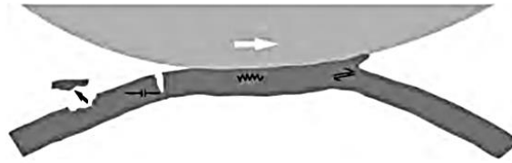
Figura 2.10 Los mecanismos tribológicos micromecánicos consideran la tensión, la deformación, la generación y propagación de grietas y la formación de partículas individuales en un micro nivel, por lo general esto es lo que ocurre en los contactos de rugosidad [18].
