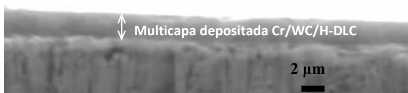
Figura 4.1 Micrografía con SEM en sección transversal del H-DLC depositado sobre el acero AISI 4140.
