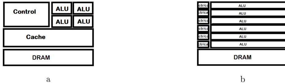
Figura 4.1: Distribución de memoria en CPU (a) y GPU (b) (NVIDIA, 2017).
