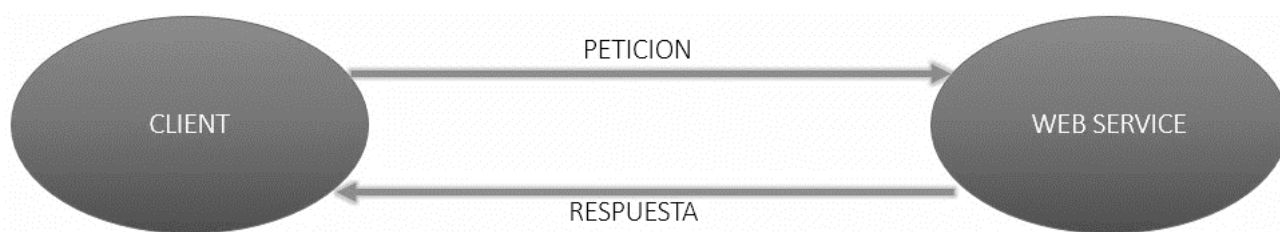
Figura 4. 20 Funcionamiento básico de un servicio web
