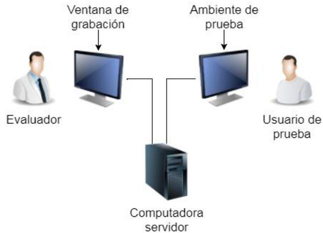
*Figura 6-8. Representación de la aplicación de la evaluación de la experiencia del usuario de una herramienta de software con el sistema de grabación.*
