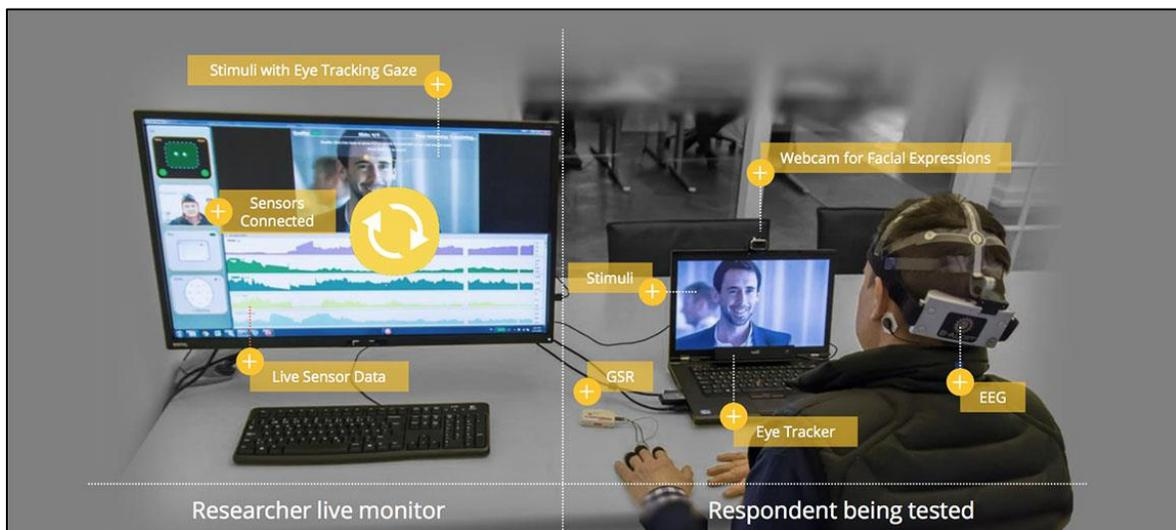
Figura 3-6. Instalación de laboratorio de la plataforma iMotions, según su página de internet y documentación (iMotions A/S, 2017).
