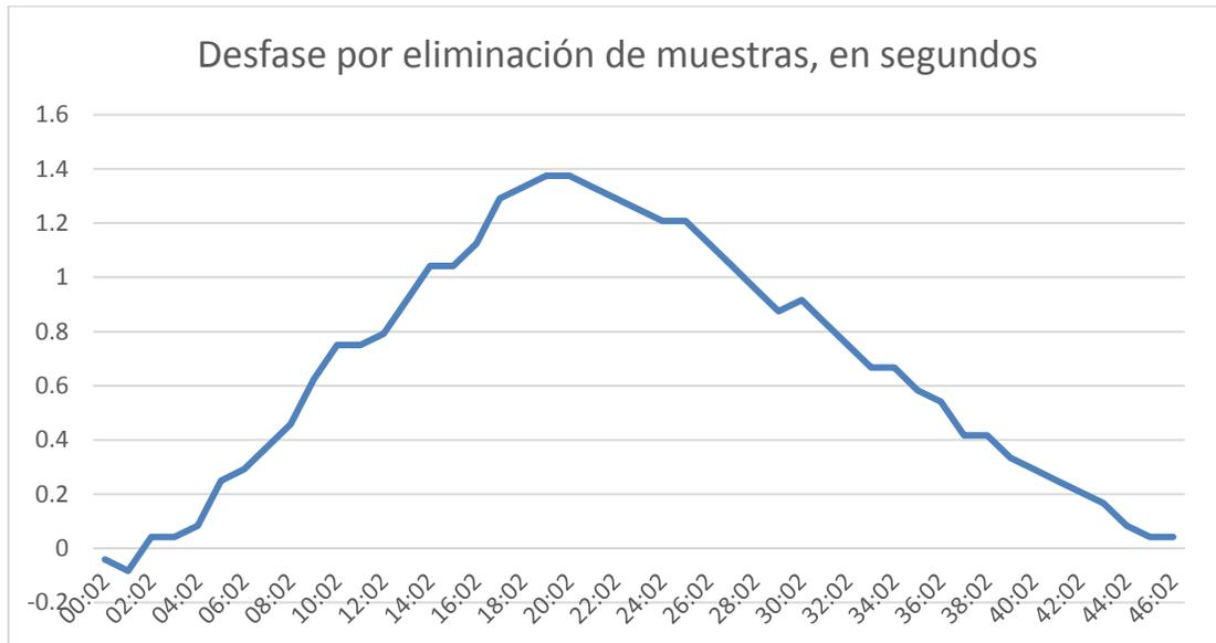
*Figura 8-8. Gráfica con datos detallados del desfase resultante provocado por la fórmula de corrección negativa de muestras de un video de 1 minuto.*
