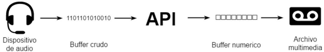
Figura 7-18. Diagrama secuencial de procesamiento de datos de audio.
